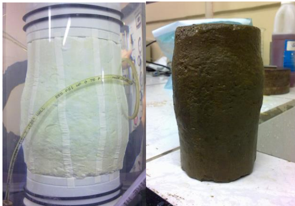
Figura 23. Muestra de suelo Guadalupe después de ser fallada. Bagnarello Madrigal. Programa Paint
