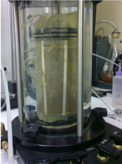
Figura 22. Muestra de suelo Guadalupe en proceso de saturación, se observa la parte inferior de un color más oscuro debido al agua que está pasando a través de la probeta. Bagnarello Madrigal. Programa Paint
