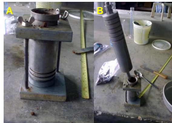
Figura 18. A) Molde metálico. B) Mazo para compactar al elaborar los especímenes para el ensayo compresión inconfiada. Bagnarello Madrigal. Programa paint
