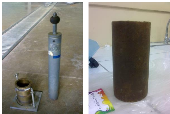
Figura 20. Probeta de Suelo Heredia para el ensayo de compresión triaxial, molde y mazo utilizado para su elaboración. Bagnarello Madrigal. Programa paint
