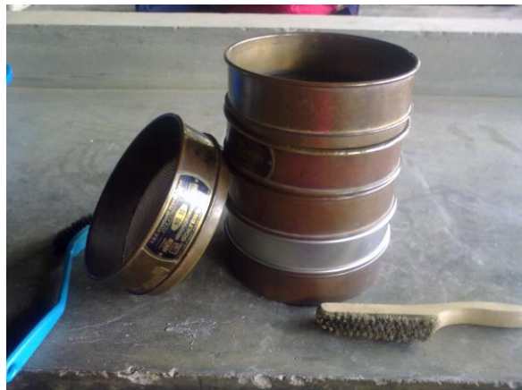
Figura 15. Mallas de trama cuadrada utilizadas en el ensayo y cepillo de bronce. Bagnarello Madrigal. Imagen Paint
