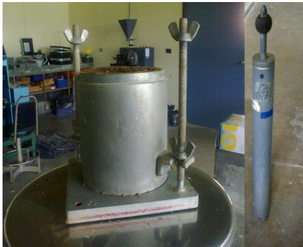
Figura 17. Molde metálico sin collarín y martillo de compactación para el ensayo de Proctor Estándar. Bagnarello Madrigal. Programa Paint
