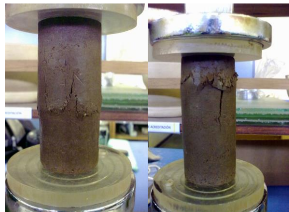
Figura 19. Deformaciones sufridas en las probetas falladas, muestras de diferentes suelos y distintas saturaciones. Bagnarello Madrigal. Programa Paint
