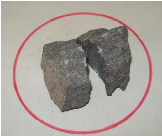
Figura 26. Roca fragmentada por carga puntual mediante un par de puntas cónicas. M-4 Fuente: Autora
