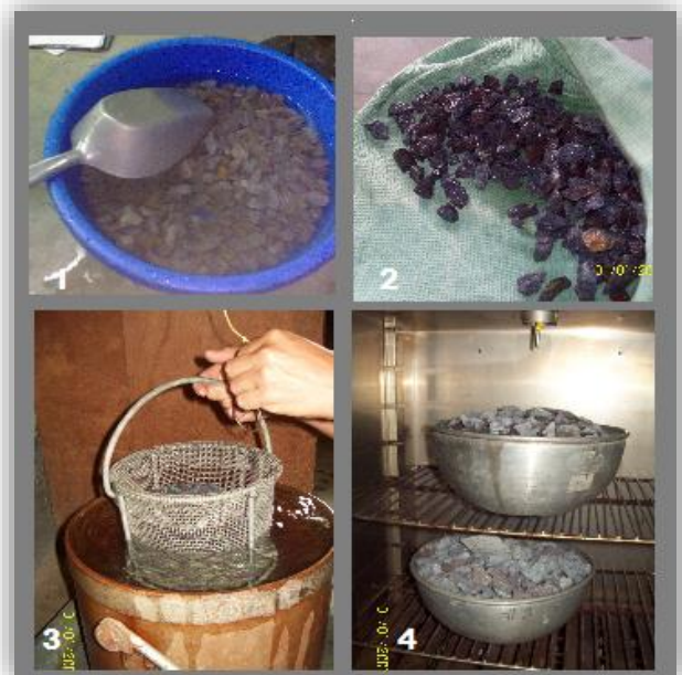
Figura 12. Ilustración de pasos para determinar las tres condiciones de pesos, con base en la muestra saturada con superficie seca ( G_{bs} ) y con base en la muestra secada al horno ( G_b ) y el peso específico aparente ( G_s ). Además del porcentaje de absorción del agregado grueso.
