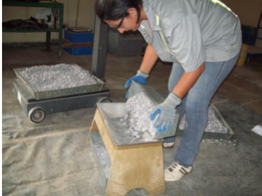
Figura 6. Ilustración de cuarteo mecanizado de material a analizar. Fuente: Autora.
