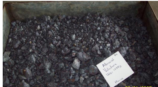
Figura10. Material posterior del ensayo de la máquina de los Ángeles. M-1. Fuente: Autora.
