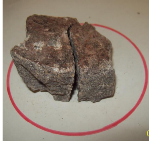
Figura 27. Roca fragmentada por carga puntual mediante un par de puntas cónicas. M-5. Fuente: Autora
