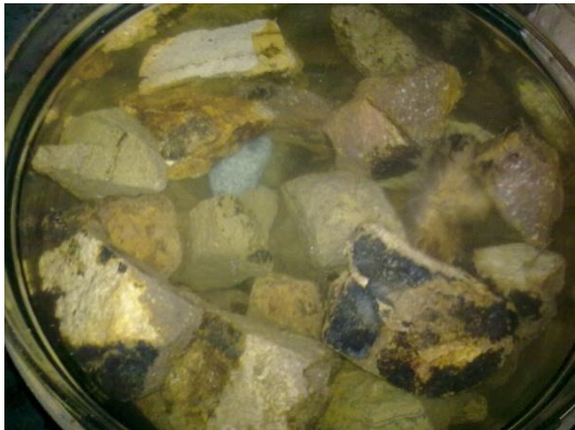
Figura 50. Muestra Adicional analizada en inmersión en etilenglicol, por periodo un periodo de 22 días. Fuente: Autora
