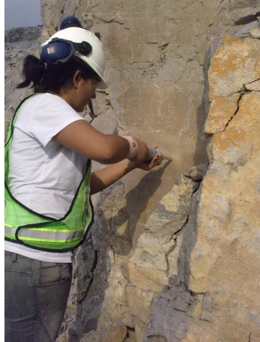
Figura 31. Determinación del Número de rebote con el esclerómetro en uno de los taludes de análisis. Fuente: Autora.
