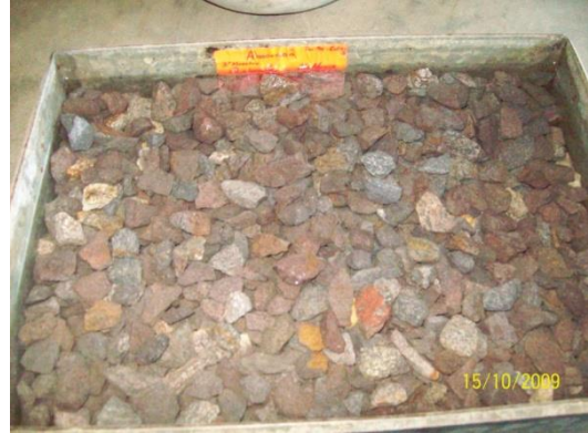
Fuente 15. Material sumergido 24 Horas, Agregado saturado Fuente: Autora.
