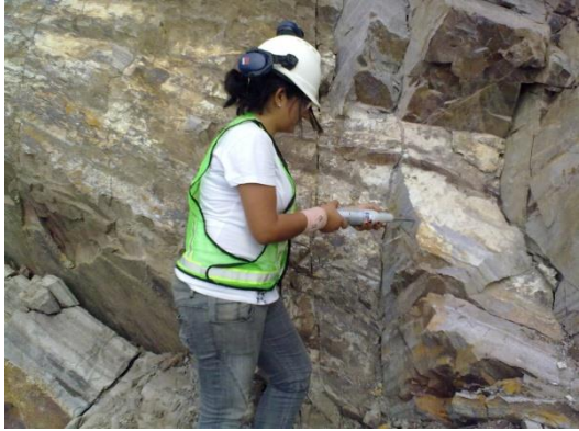
Figura 31. Determinación del Número de rebote con el esclerómetro en uno de los taludes de análisis. Fuente: Autora.
