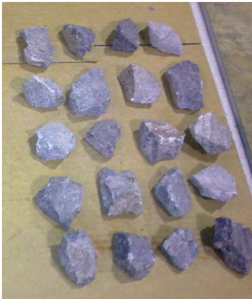
Figura 22. Algunos Especímenes a fallar en la prueba de Carga Puntual M-4, Ret 1 1/2" Fuente: Autora
