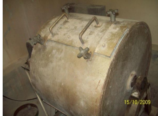
Figura 8. Máquina de Los Angeles donde se realizó la abrasión de los materiales. Fuente: Autora
