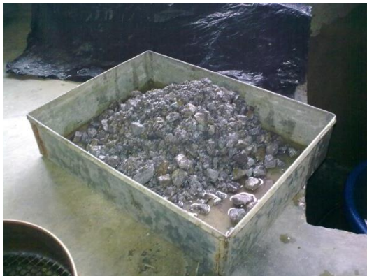
Figura 13. Material posterior al ensayo en la máquina de los Ángeles. M-5. Fuente: Autora.
