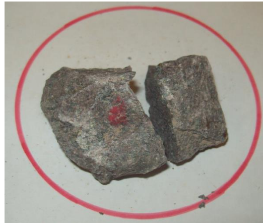
Figura 23. Roca fragmentada por carga puntual mediante un par de puntas cónicas. M-1. Fuente: Autora
