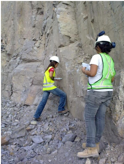
Figura 30. Análisis del talud con el esclerómetro por parte de la Geóloga Mauren Carrilo de Holcim Fuente: Autora
