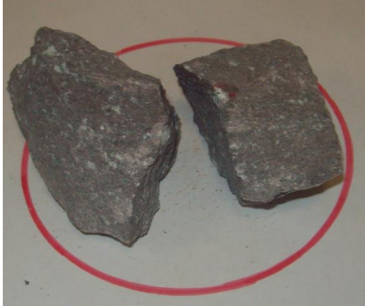
Figura 25. Roca fragmentada por carga puntual mediante un par de puntas cónicas. M-3. Fuente: Autora
