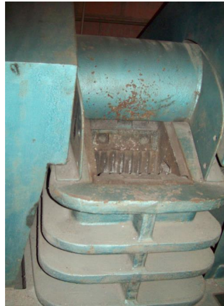
Figura 4. Trituradora de mandíbula de la Escuela de Ing. Materiales I.T.C.R, usada para el material obtenido in situ. Fuente: Autora.
