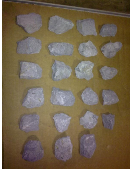
Figura 20. Algunos Especímenes a fallar en la prueba de Carga Puntual M-1, Ret 1 ½". Fuente: Autora
