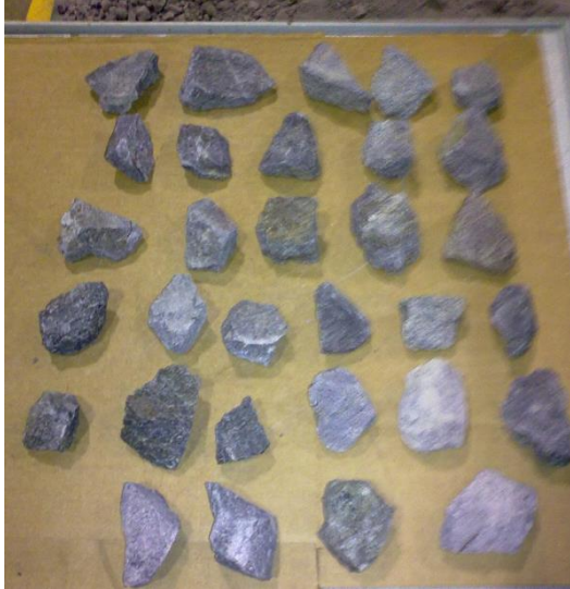
Figura 22. Algunos Especímenes a fallar en la prueba de Carga Puntual M-3, Ret 1" Fuente: Autora
