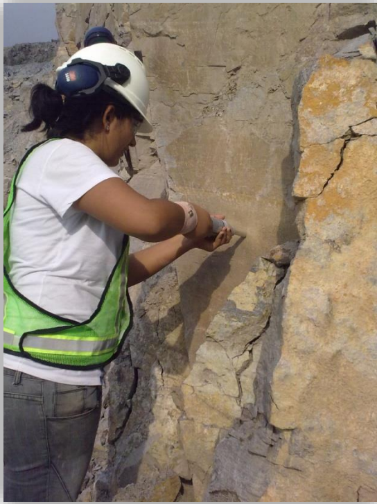
Figura 14. Ilustración de Prueba del Esclerómetro in situ.
