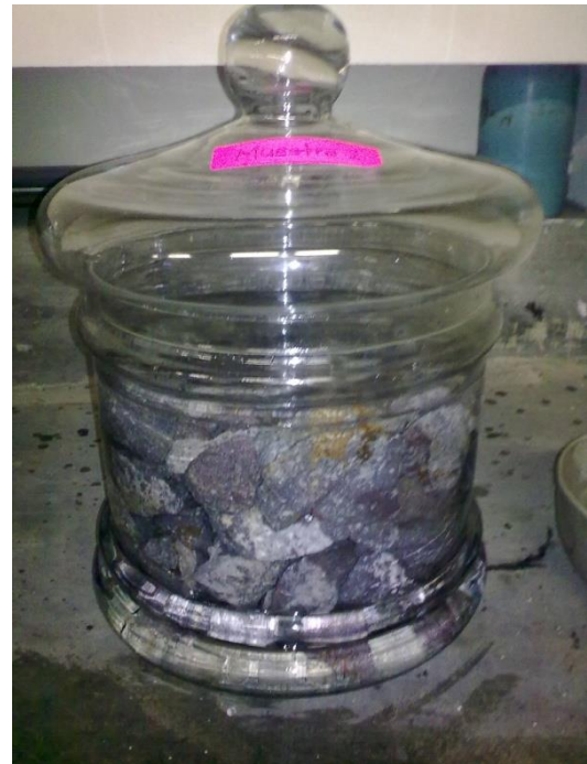
Figura 40. Muestra M-1, en su inmersión en Etilenglicol por un periodo de un mes. Fuente: Autora.
