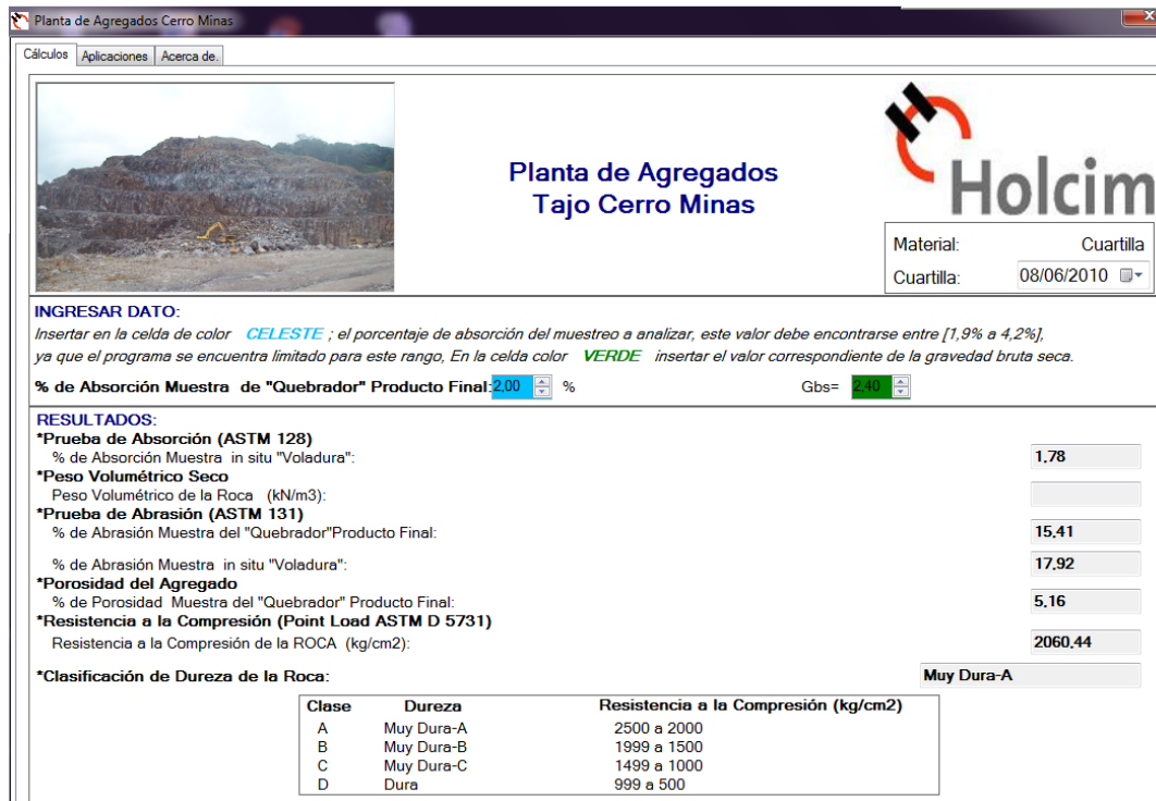
Figura 30. Programa ejecutable que estima características físicas y parámetros mecánicos de los materiales rocosos de Cerro Minas.
