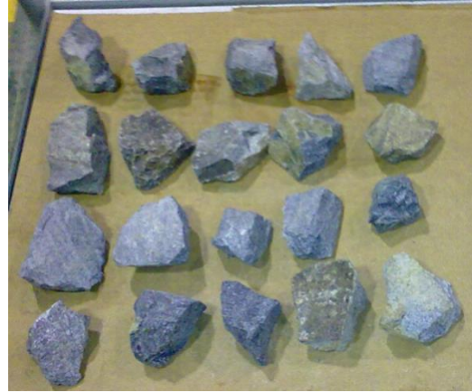
Figura 22. Algunos Especímenes a fallar en la prueba de Carga Puntual M-4, Ret 1" Fuente: Autora
