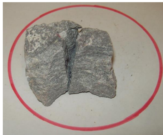
Figura 24. Roca fragmentada por carga puntual mediante un par de puntas cónicas. M-2. Fuente: Autora
