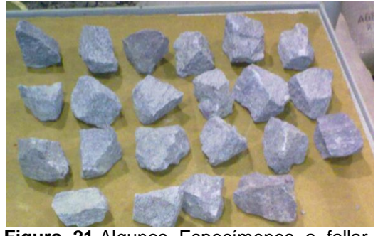
Figura 21. Algunos Especímenes a fallar en la prueba de Carga Puntual M-2, Ret 1 ½". Fuente: Autora
