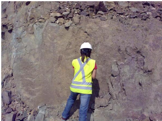
Figura 33. Análisis del Talud para determinar el número de rebote con el esclerómetro. Fuente: Autora.
