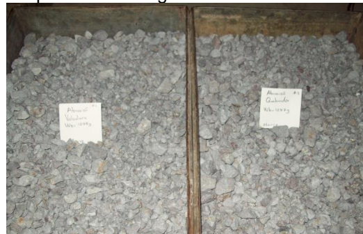
Figura11. Material posterior del ensayo en la máquina de los Ángeles. M-2 Fuente:Autora
