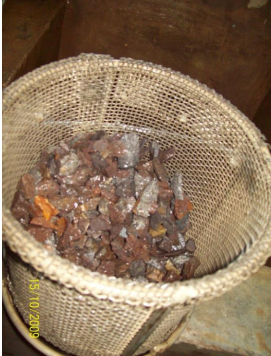
Figura 18. Ilustración del Material en la canasta donde se determina el peso sumergido. Fuente:Autora
