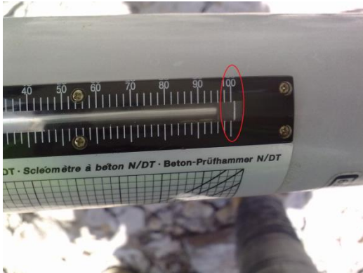
Figura 29, Ilustración del número de rebote de 100, el cual este corresponde al máximo valor del esclerómetro. Fuente: Autora
