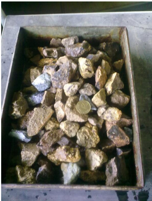
Figura 51. Muestra Adicional con presencia de arcilla. Fuente: Autora.
