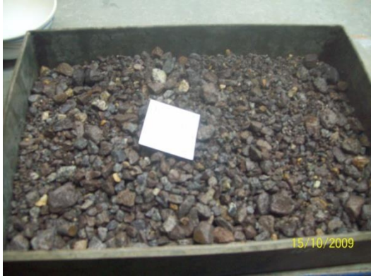
Figura 12. Material posterior al ensayo en la máquina de los Ángeles. M-3. Fuente: Autora.
