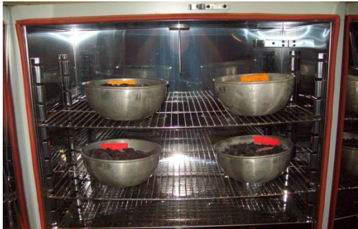
Figura 19. Material en el horno para determinar la condición de Peso seco del agregado. Fuente: Autora.
