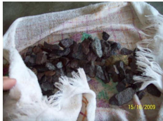
Figura 16. Material en proceso de Saturado Superficie Seca. Fuente: Autora
