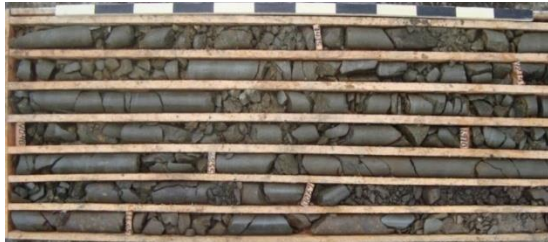
Figura 17. Perforación PHCHT2 – 3 (Tanque de Oscilación) de 65,15m a 74,85m.
