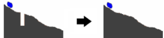
Figura 5. Ilustración de la corrección de las concavidades.
