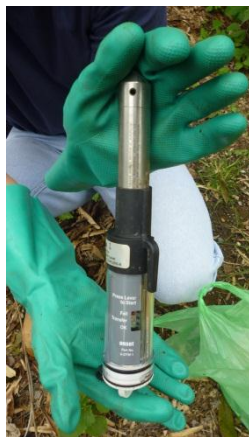
Figura 28. Momento en que los registros del sensor de nivel HOBO modelo U20 eran descargados.
