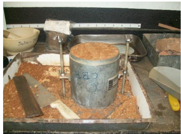
Figura 24. Especimen elaborado con el contenido de humedad de campo para determinar la posible relación entre el CBR y el valor del Coeficiente de Balasto.
