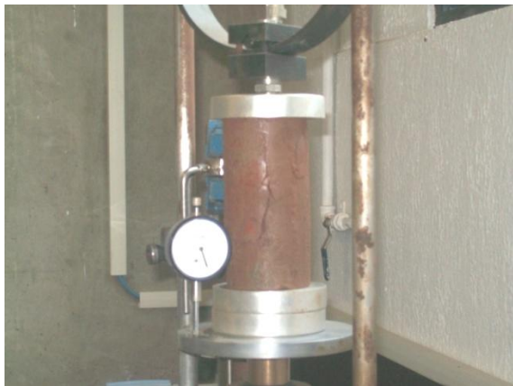
Figura 25. Ensayo de compresión inconfinada para una muestra inalterada obtenida del Sitio 02 - Puesto 07 P.H. Reventazón.
