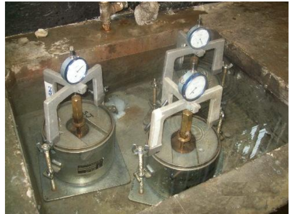
Figura 23. Saturación de los especímenes reproducidos para el ensayo CBR.
