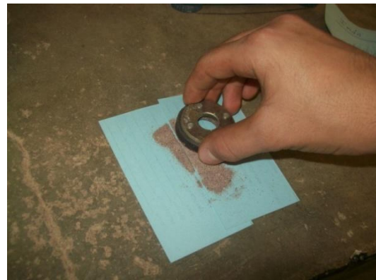
Figura 37. Colocación del imán sobre la muestra del Sitio 02 – Puesto 07, P. H. Reventazón, para comprobar la presencia de material metálico.
