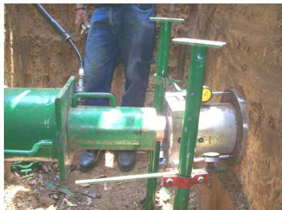
Figura 11. Equipo del ensayo de placa horizontal colocado dentro de la trinchera, Sitio 01-Higuito de Desamparados.
