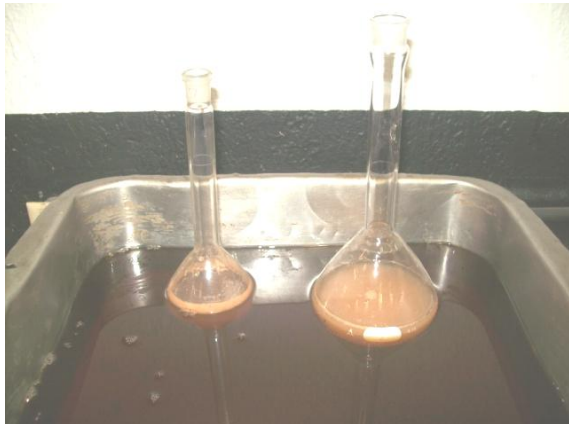
Figura 19. Muestras del material de cada sitio hervidas dentro de los picnómetros para la determinación de la Gravedad específica. Derecha: Material del Sitio 01; izquierda: Material de Sitio 02.
