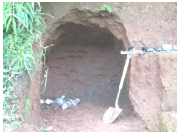
Figura 17. Recuperación de muestras inalteradas, Sitio 02-Puesto 07 P.H. Reventazón.
