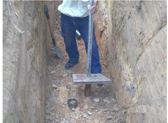
Figura 16. Recuperación de muestras inalteradas, Sitio 01-Higuito de Desamparados.
