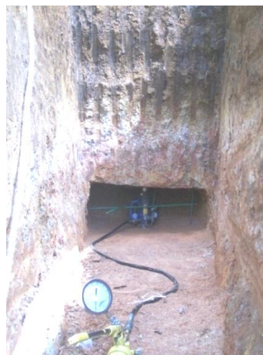
Figura 13. Equipo del ensayo de placa colocado en el nicho, Sitio 01-Higuito de Desamparados.
