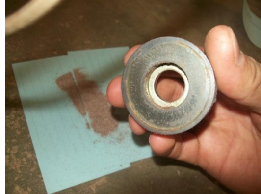
Figura 36. Muestra del material del Sitio 02 – Puesto 07, P. H. Reventazón, secado al horno e imán limpio antes de la comprobación de presencia de metales en la muestra.
