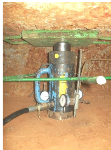
Figura 12. Equipo del ensayo de placa colocado en el nicho, Sitio 01-Higuito de Desamparados.
