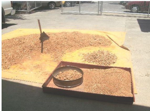
Figura 27. Material secado al aire libre y tamizado en la malla \frac{3}{8} ".
