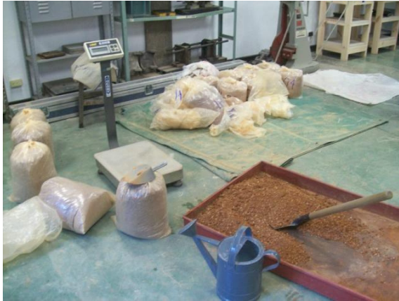
Figura 29. Adición de agua a las muestras de material para alcanzar el contenido de humedad requerido para la prueba.
