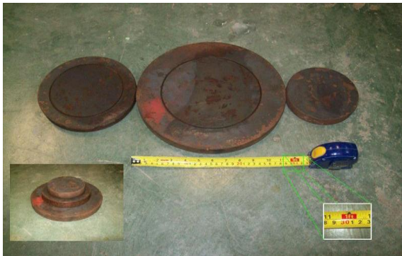
Figura 9. Placas utilizadas en los ensayos de placa de carga en campo.
