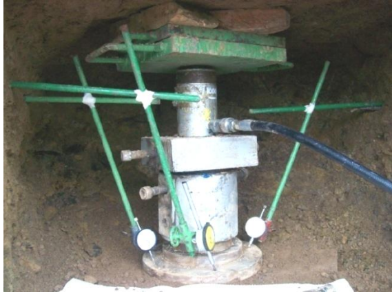
Figura 14. Equipo del ensayo de carga vertical colocado en el nicho, Sitio 02-Puesto 07 P.H. Reventazón.
