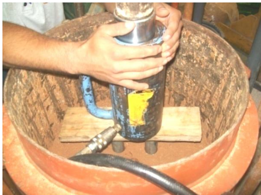
Figura 32. Extracción de las muestras inalteradas del material remoldeado en el odómetro.
