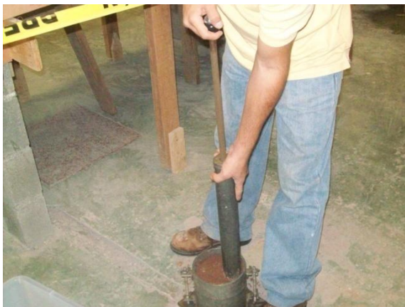
Figura 22. Compactación del material en el ensayo Próctor Estándar.
