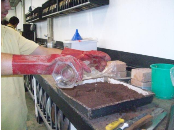
Figura 21. Preparación del material del ensayo Próctor Estándar.
