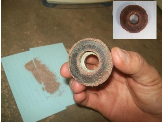
Figura 38. Material atraído al imán debido a presencia de metales en la muestra del Sitio 02 – Puesto 07, P. H. Reventazón.
