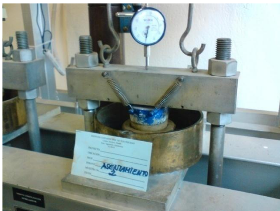
Figura 33. Ensayo de consolidación, muestra con contenido de humedad óptimo.
