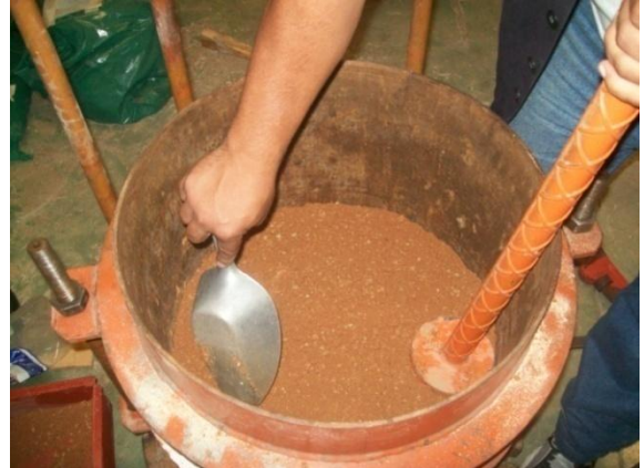
Figura 30. Llenado y compactación del odómetro para realizar el ensayo de compresión uniaxial.
