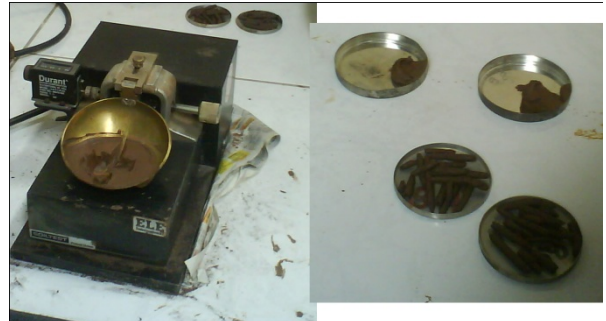
Figura 3M. Máquina de Casagrande, bastones y muestras de humedad.
