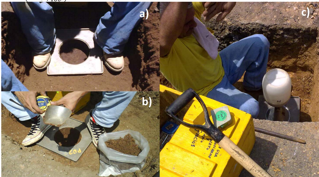
Figura 14M. Proceso de la prueba de densidad en sitio, a) Se limpia y nivela el lugar donde se va hacer la prueba, b) Se excava dentro del plato a una profundidad no mayor a 15cm y c) Se vierte la arena Ottawa en el agujero hecho.
