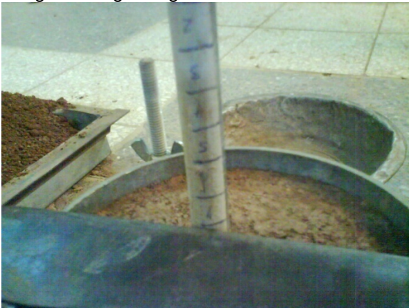
Figura 8M. Medir capas por medio de la calibración de una varilla.
