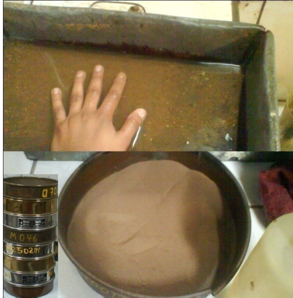
Figura 4M. Lavado de material pasando la malla 200 y tamizaje del retenido.
