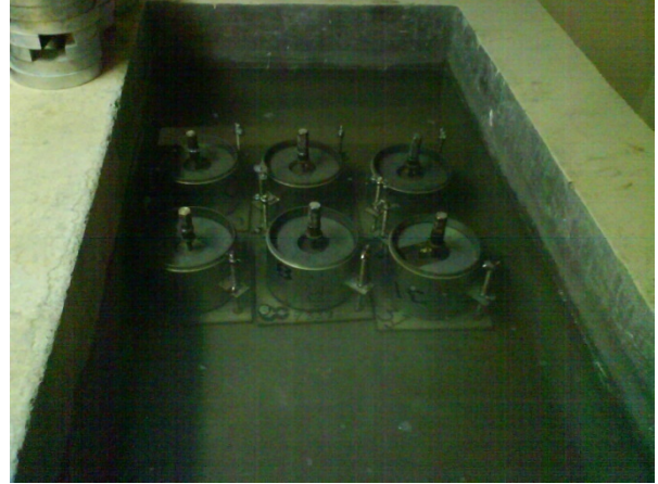
Figura 11M. Sumergimiento de moldes de CBR.
