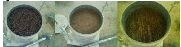
Figura 9M. Se coloca el material, se compacta y escarifica, se repite el proceso.
