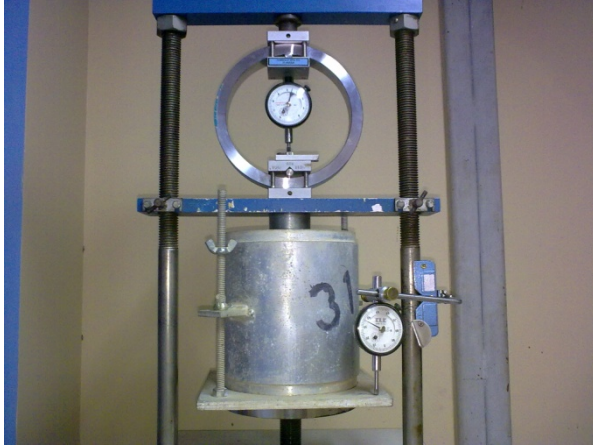
Figura 12M. Fallo de probeta en máquina de CBR.
