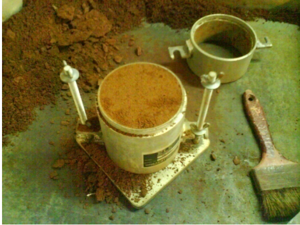
Figura 10M. Probeta conformada al ras del molde.
