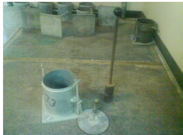
Figura 7M. Molde y mazo usados en conformación de las probetas.
