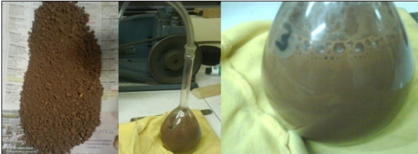
Figura 5M. Se prepara 100 g de material, se bate con agua y saca los vacíos.
