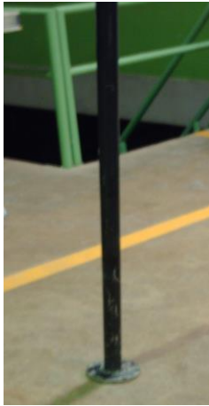
Figura 16: Mazo creado para compactar los modelos de suelo.
