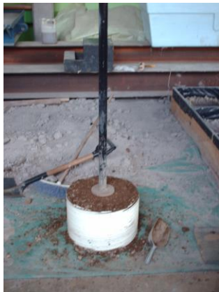
Figura 17: Molde de Rib-lock para compactar.
