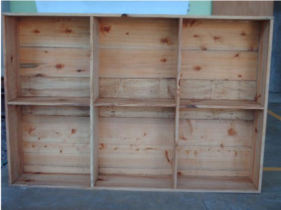
Figura 15: Molde de madera creado para construir modelos de suelo.
