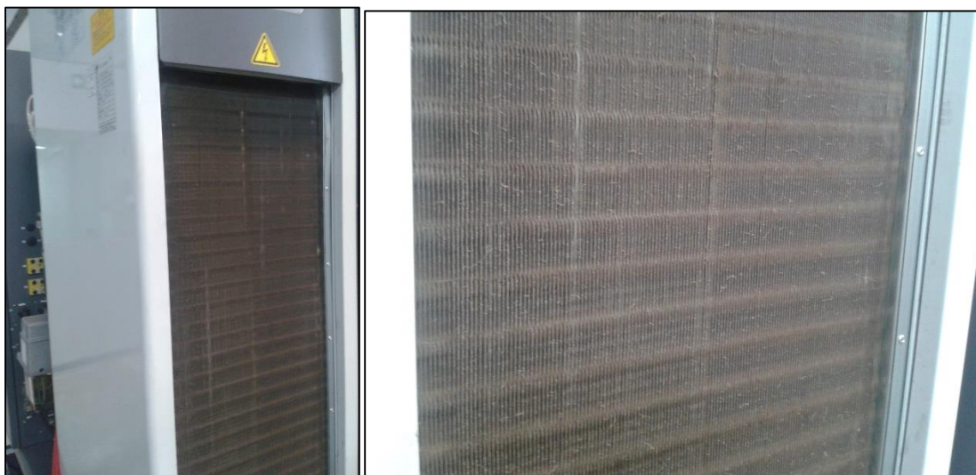
Figura 4.1 Elemento a limpiar del centro de mecanizado Okuma.
