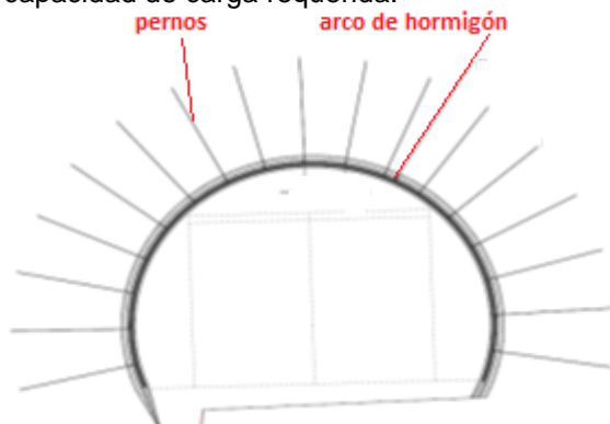
Figura 22. Costilla de hormigón proyectado (Vegagerðin, 2008)
