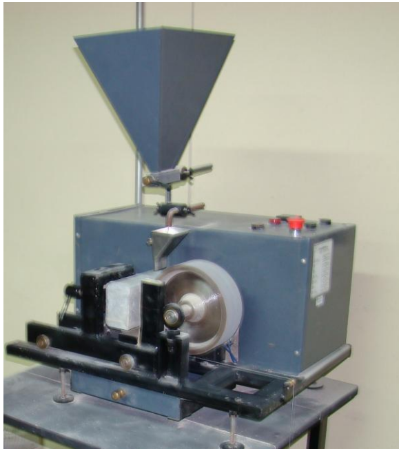
Figura 6. Tolva superior (almacenamiento de arena)
