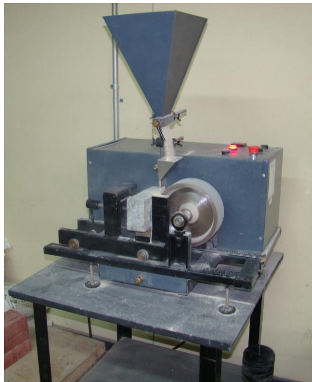
Figura 1. Partes de la máquina de resistencia a la abrasión de adoquines.
