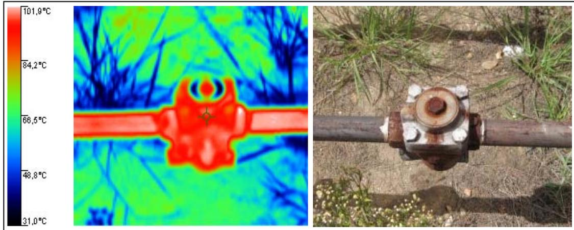
Figura 2.13 Trampa de vapor de flotador libre, bloqueada en posición abierta.
