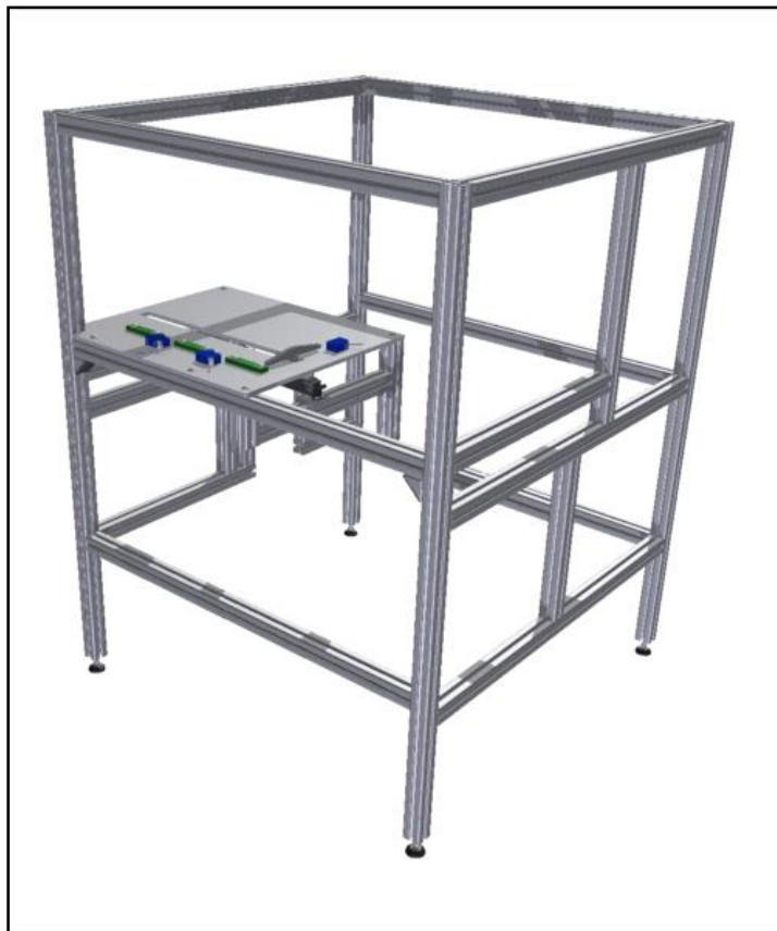
Figura 6.3. Estructura original de la máquina junto con el sistema diseñado.
