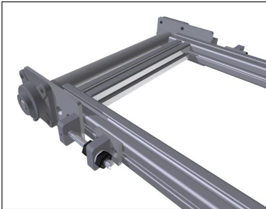
Figura 5.22. Montaje de los elementos tensores.
