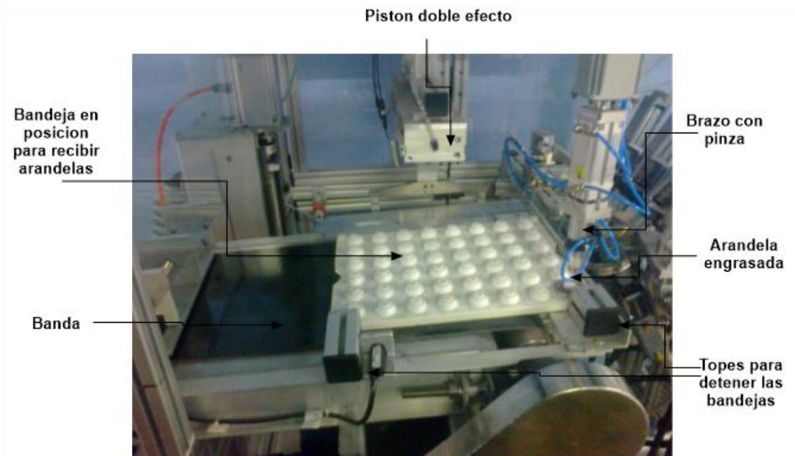
Figura 1.3. Detalle de la máquina dosificadora de grasa.
