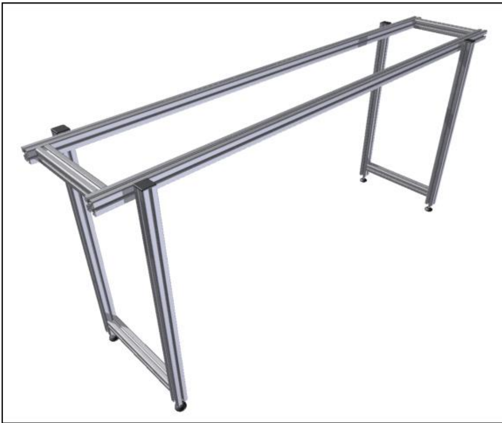
Figura 5.17. Estructura de la banda transportadora.
