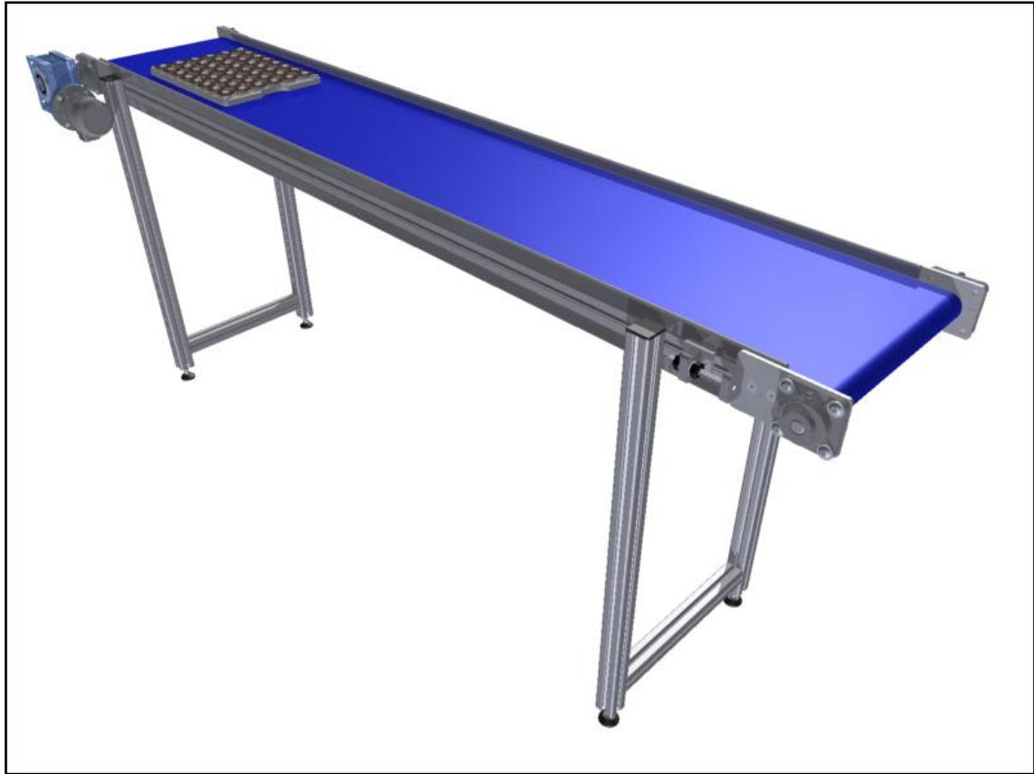
Figura 6.4. Ensamble de la banda transportadora.
