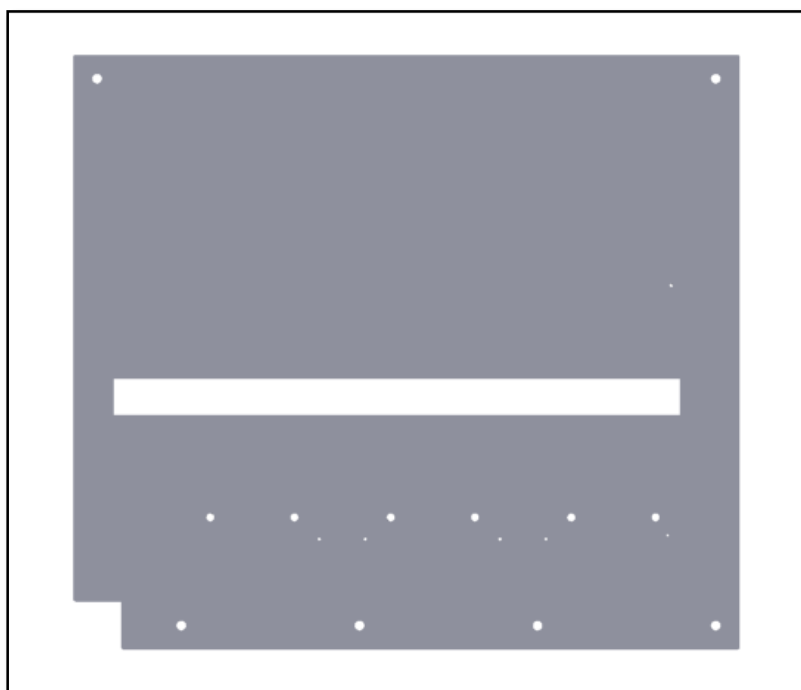
Figura 5.14. Forma de la lámina de aluminio que representa a la base.
