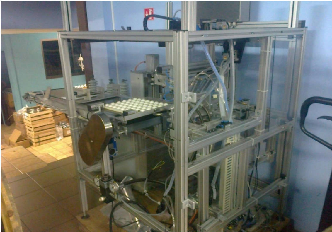
Figura 1.2. Máquina dosificadora de grasa para arandelas de la empresa Controlsoft.
