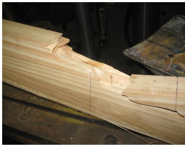
La viga VRA se segmentó en dos elementos independientes.
