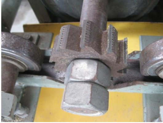
Figura 24. Cuchillas encargadas de cepillar los segmentos de la caña de bambú.
