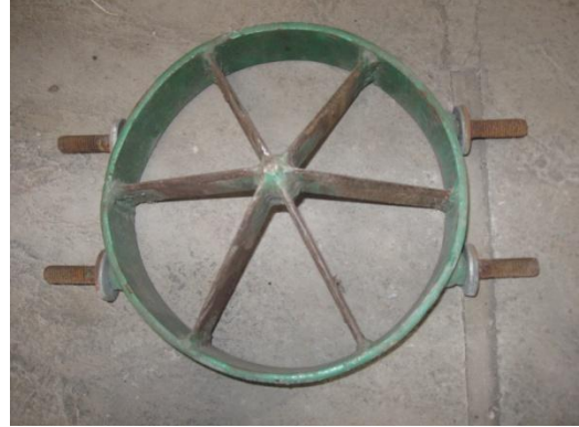
Figura 22 .Cuchillas encargadas de dividir la caña de bambú.
