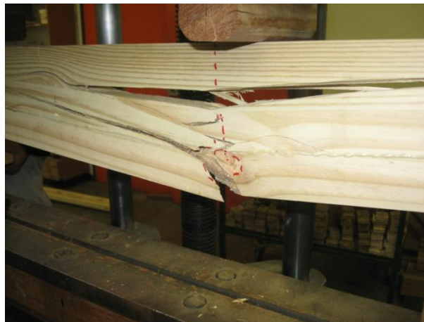
Detalle de falla a tensión en el espécimen VS8.
