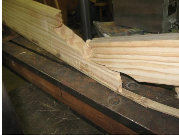
Falla de la viga VRI.
