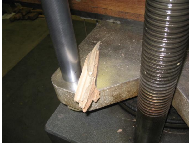
Desprendimiento de bloques en la falla.
