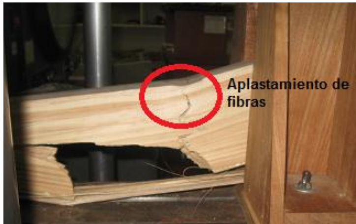
Detalle de la falla por aplastamiento del espécimen VRA.
