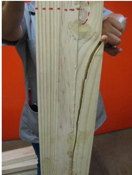
Detalle de falla por tensión en el espécimen VS1
