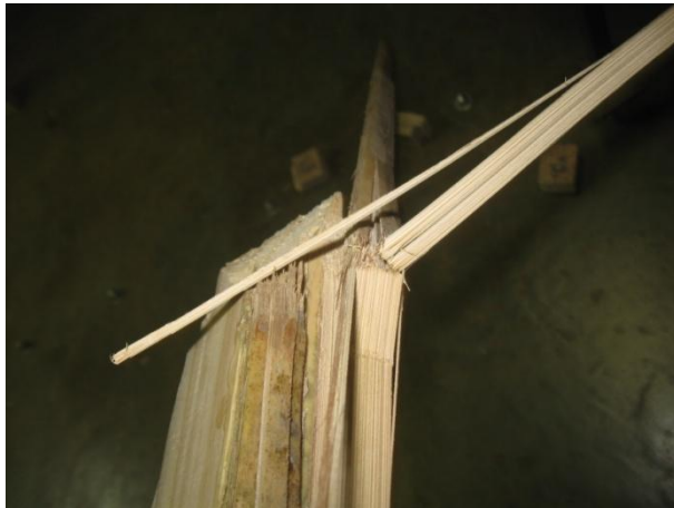
Falla del refuerzo en tensión justo en uno de los nudos.
