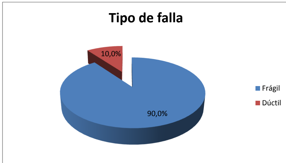
Figura 67. Recurrencia de fallas según tipo de falla para las vigas sin refuerzo.
