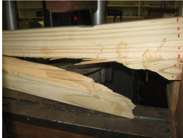
Detalle de la falla por cortante del espécimen VS10.
