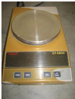
Figura 42. Balanza digital necesaria para determinar contenido de humedad y densidad.
