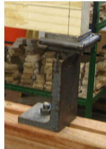
Figura 52. Detalle de uno de los apoyos
