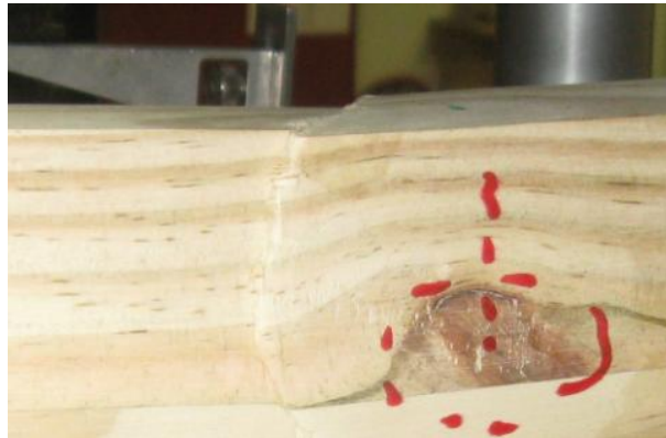
Detalle de falla a compresión en el espécimen VS6. Aplastamiento en la zona en compresión.
