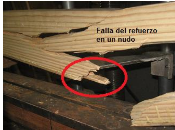
Detalle de la falla en tensión de la viga VRB.
