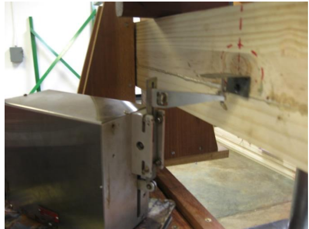
Figura 57. Colocación de deformímetro (LVDT).
