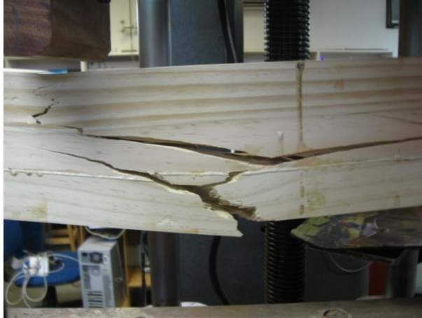
Detalle de falla por tensión en el espécimen VS3.
