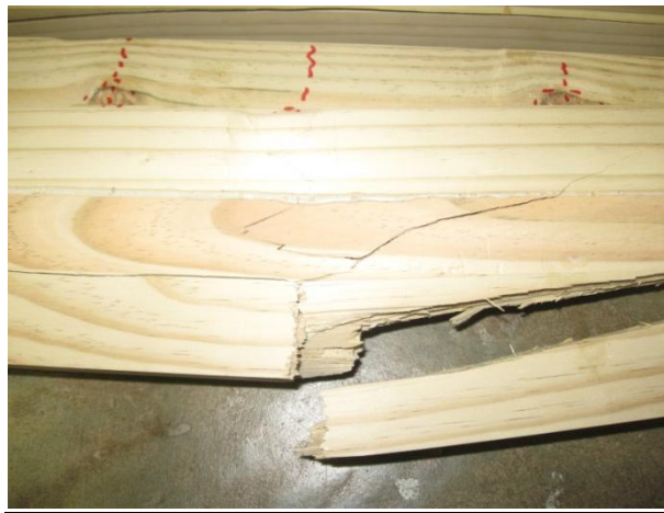
Detalle de falla a tensión en el espécimen VS7.
