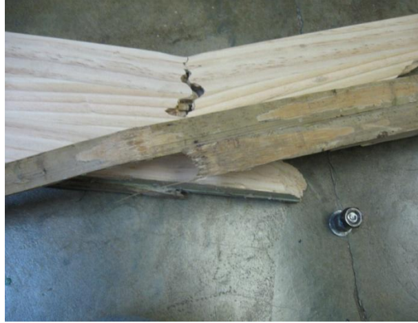
Detalle de la falla del bambú justo en uno de los nudos
