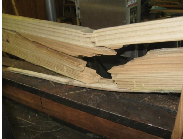
Falla en tensión del espécimen. Se aprecia la ruptura del refuerzo en un nudo.
