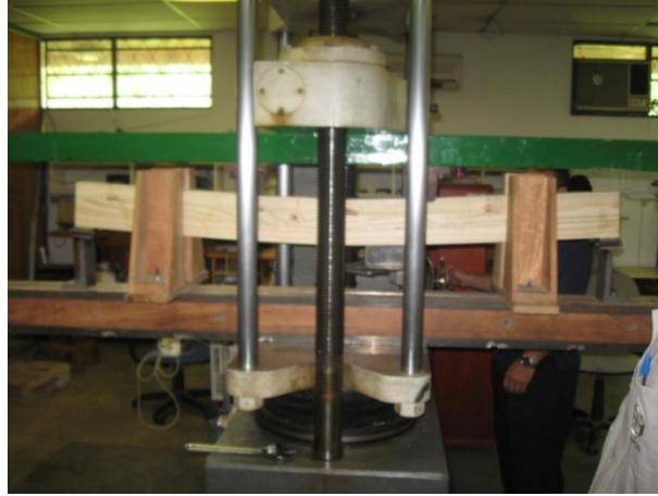
Detalle de falla a compresión en el espécimen VS6. Se aprecia la alta deformación y que la viga no pierde su integridad.
