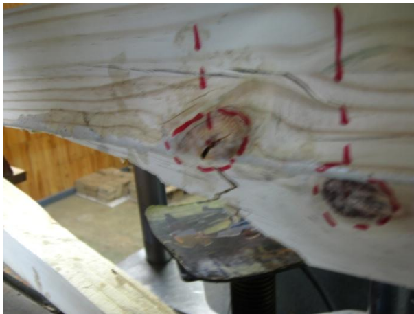
Detalle de falla por tensión en el espécimen VS4.
