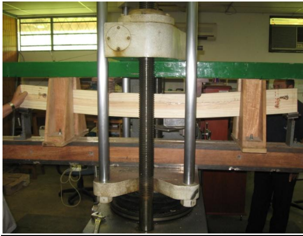
Detalle de la alta deformación del espécimen VS9. La viga se mantiene íntegra estructuralmente.
