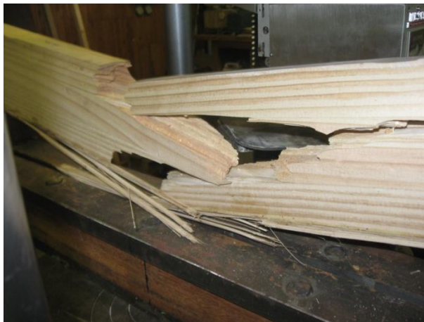
Falla de la viga VRH.
