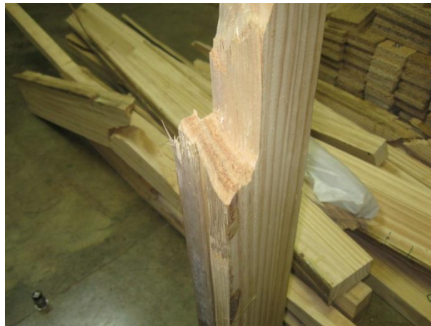
Falla en tensión del refuerzo.
