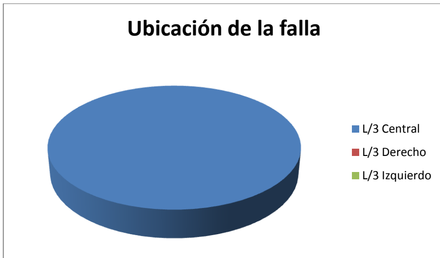
Figura 66. Recurrencia de fallas según ubicación de la falla para las vigas sin refuerzo.
