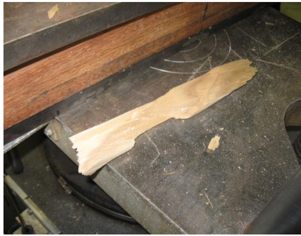
Desprendimiento de un bloque de madera producto de la falla explosiva.
