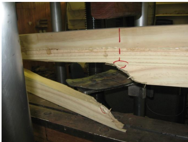
Detalle de falla por cortante en el espécimen VS5. La grieta se da en el tercio izquierdo.
