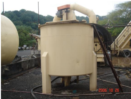
Fotografía 2. Equipo de almacenamiento y de inyección del látex a la planta donde se produce la mezcla asfáltica.
