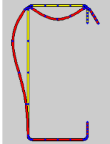
Figura 9. Pandeo local del alma, ala y atiesador de un perfil tipo C, sometido a flexión. Imagen tomada del programa CUFSM.
