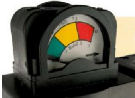
Figura 20 Medidor de diferencia de presión de un filtro marca Kaeser [13]
