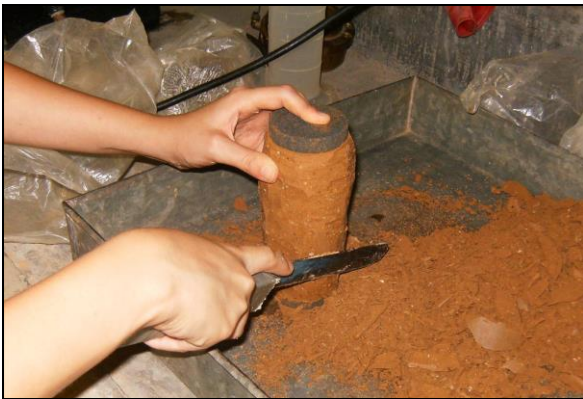
Figura 27. Etapa de talle y corte de un espécimen remoldeado.
