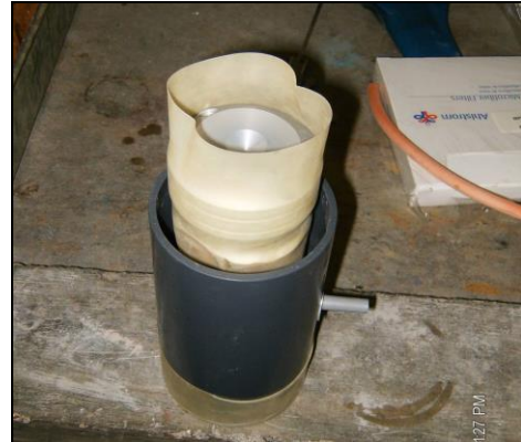
Figura 29. Colocación de la membrana de hule utilizando el emplazador de PVC.
