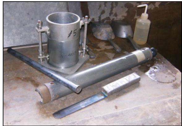
Figura 26. Equipo de compactación utilizado en la preparación del espécimen del ensayo triaxial.
