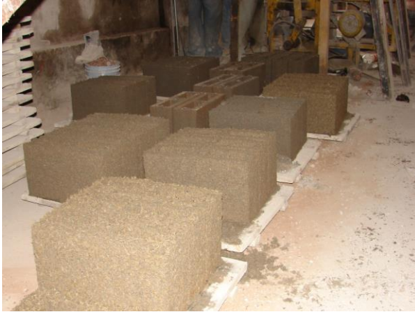
Figura 4. Aspecto de varias camadas de bloques con distintas mezclas
