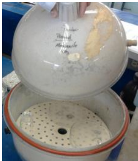
Figura 4. Desecador para producción de membranas, formador de atmósfera de amoniaco.
