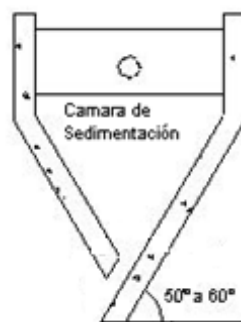
Figura 22. Detalle del área de sedimentación de un tanque Imhoff
