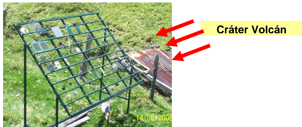
Figura 8: Disposición de probetas de diferentes materiales para estudio cualitativo de corrosión atmosférica en el volcán Turrialba.
