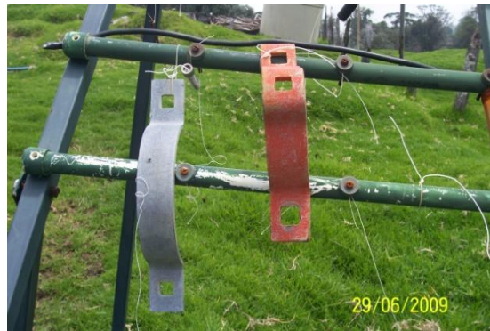
Figura 18: Piezas del ICE galvanizadas por inmersión, después de 8 meses de exposición a 3 Km del cráter del volcán Turrialba.
