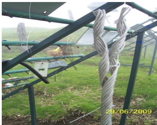
Figura 19: Cables de aluminio, después de 8 meses de exposición a 3 Km del cráter del volcán Turrialba.
