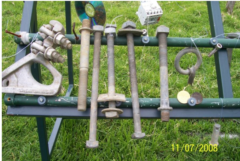
Figura 9: Probetas proporcionadas por el ICE para ser estudiadas en un estudio cualitativo de corrosión atmosférica en el volcán Turrialba.
