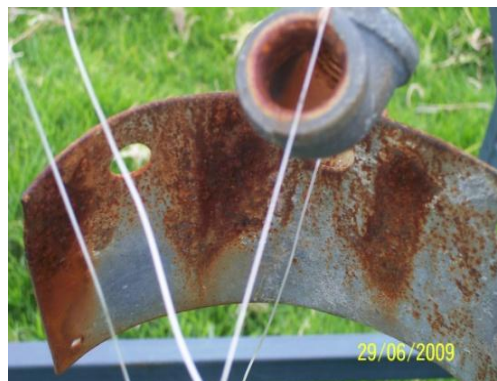
Figura 17: Piezas del ICE zincadas electrolíticamente después de 8 meses de exposición a 3 Km del cráter del volcán Turrialba.
