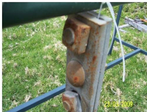
Figura 17: Piezas del ICE zincadas electrolíticamente después de 8 meses de exposición a 3 Km del cráter del volcán Turrialba.
