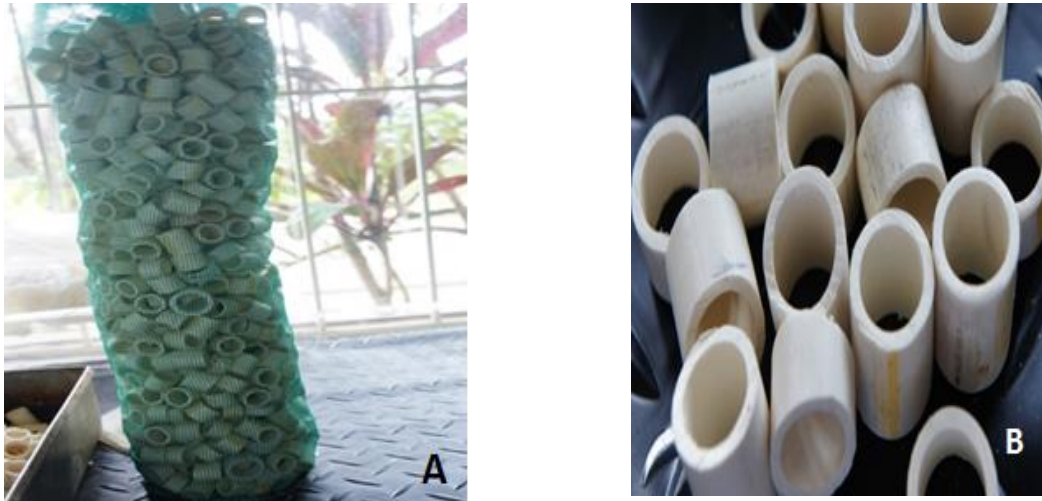
Figura 3-4. A: Medio filtrante. B: Material de relleno.
