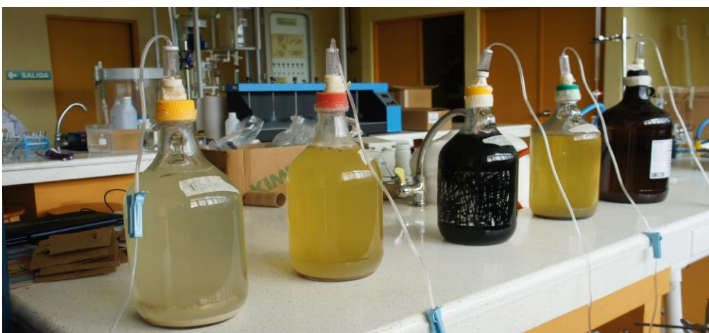
Figura 7-3. Pruebas de actividad metanogénica con adición de alcalinizante y nutrientes
