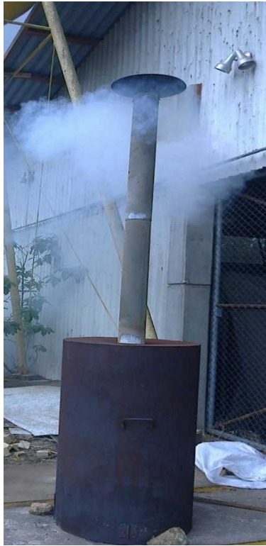
Figura 4.1 Emisión de humo en el carbonizador en la fase pirolítica
