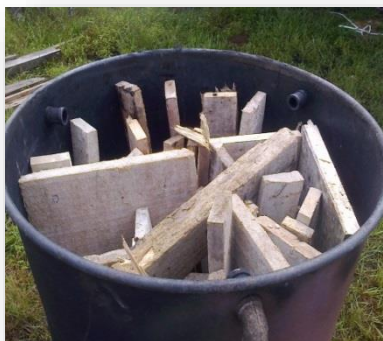
Figura 3.5 Colocación de la biomasa en el barril.
