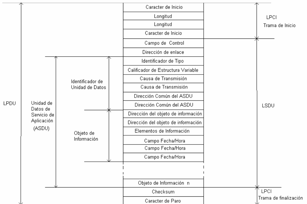
Figura A2.4 Estructura de un mensaje (LPDU) en el protocolo IEC 870-5
