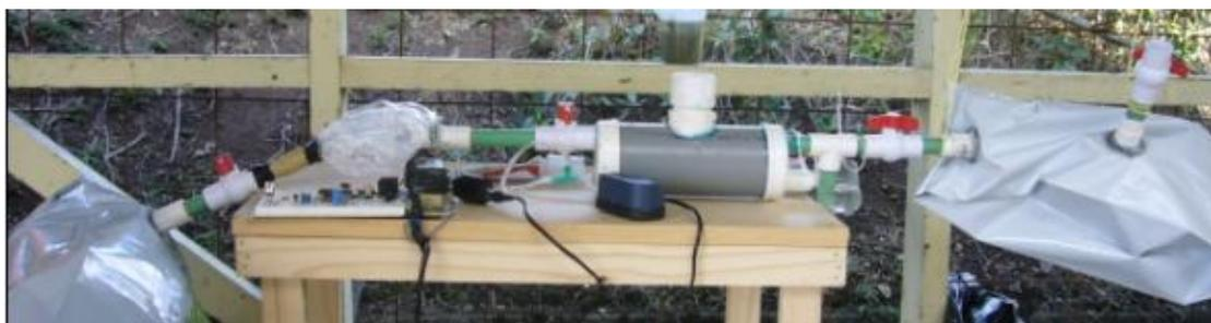
**Figura 20.** Sistema de desulfuración biológica adaptado para el tratamiento de una muestra de biogás tomada del biodigestor de la finca La Floresta.
