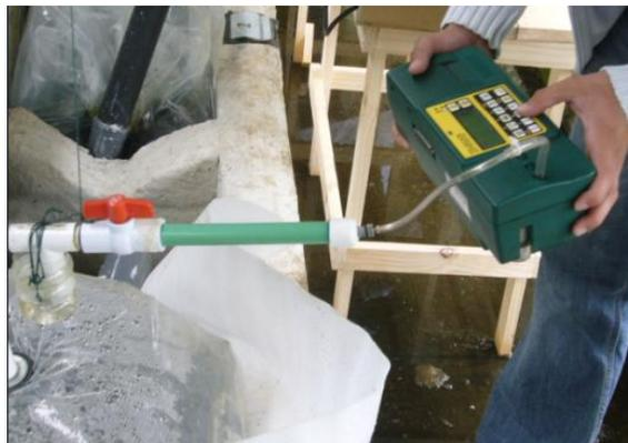
**Figura 10.** Detección de la concentración de  $H_2S$  por medio del analizador Tempest 100.
