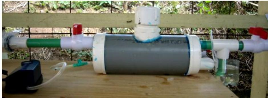
**Figura 18.** Tanque utilizado para la remoción biológica del  $H_2S$  de una muestra de biogás.
