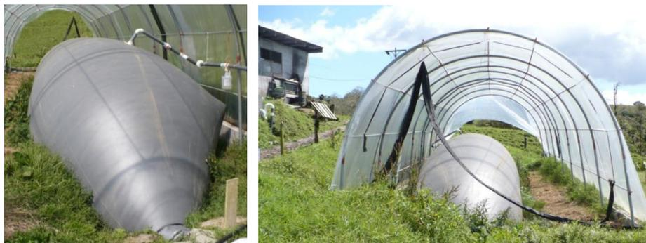
**Figura 7.** Biodigestor tipo Taiwán de la finca La Floresta.
