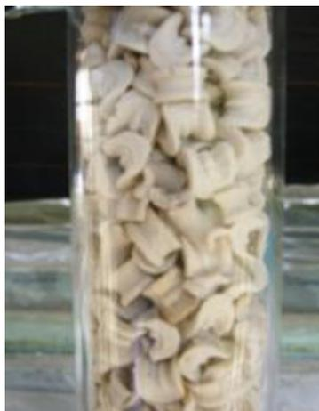
**Figura 16.** Material de empaque utilizado para el relleno de la columna de absorción
