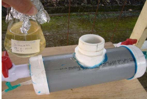
**Figura 12.** Inoculación de los cultivos de *S.novella* y *A. thiooxidans* en el tanque de desulfuración biológica.
