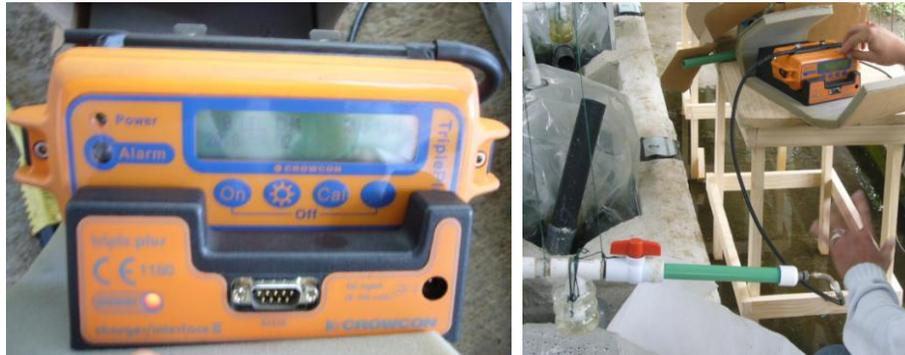
**Figura 9.** Analizador Triple Plus IR utilizado para determinar el porcentaje de metano del biogás.
