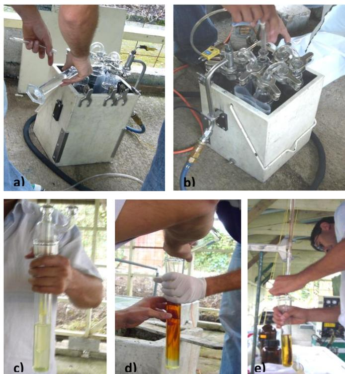
**Figura 11.** Determinación analítica de la concentración de  $H_2S$  en el biogás por el método USEPA 11.
