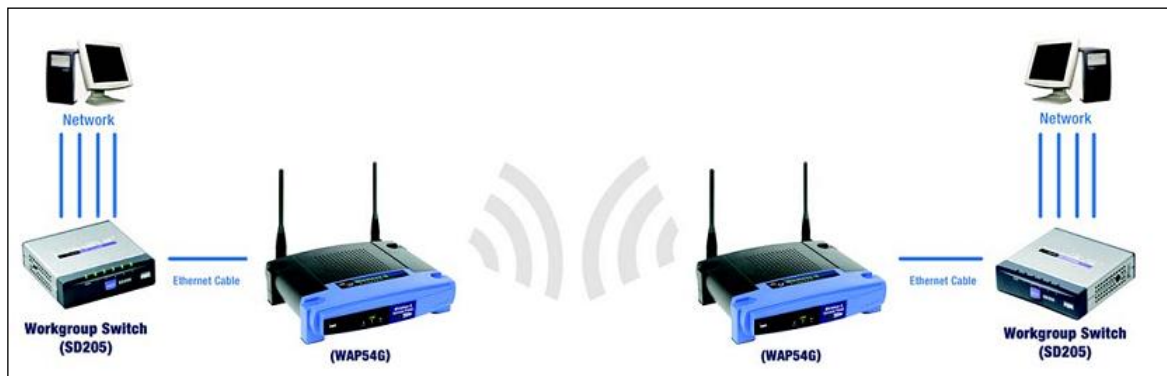
Figura 5.10 Diagrama del puente inalámbrico creado con los puntos de acceso WAP54G de Linksys
