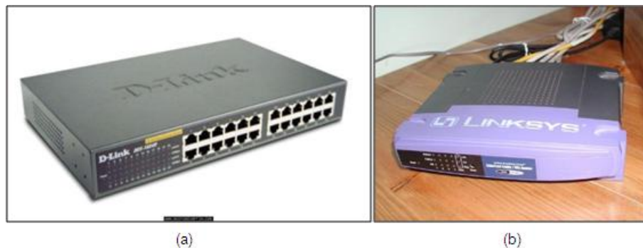
Figura 5.7 Switch presente en la oficina del departamento de electromecánica (a) y router utilizado como Gateway en la Red TCP/IP (b)
