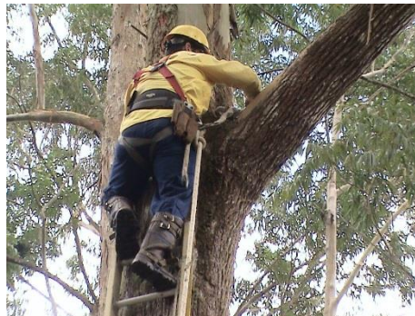
Figura Q. Sujeción con el estrobo
