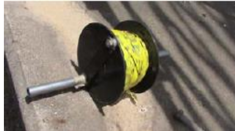
Figura H. Dispositivo para la recolección de cinta de demarcación de zona de trabajo.
