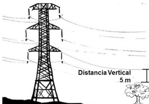
Figura G. Distancia mínima vertical entre conductor y ramas del árbol o equipo trabajo.
