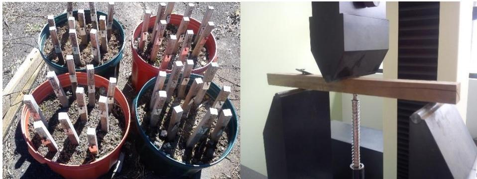
**Figura 3.** Prueba de campo para la madera termo-tratada (A). Ensayo de flexión estática (B).
