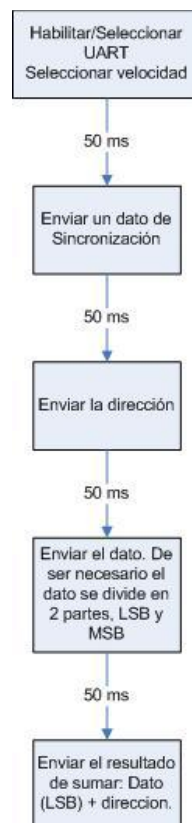
Figura 5.3.2-4. Secuencia de envío de datos mediante RS232
