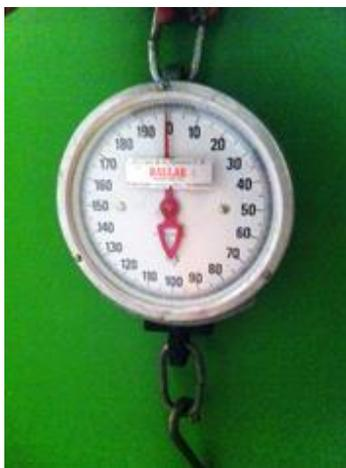
Figura 7.2: Báscula de gancho utilizada para el pesaje de RS ordinarios en el estudio de composición y generación
