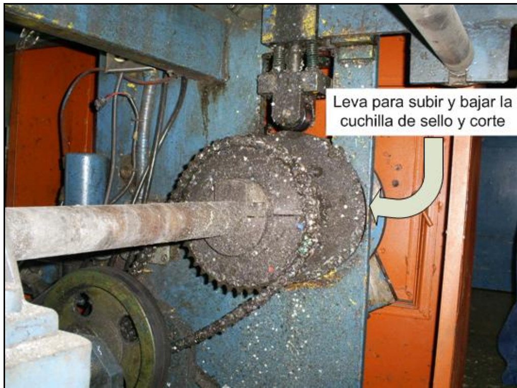
Figura 4.2 Eje principal y leva para subir y bajar la cuchilla de sello y corte.
