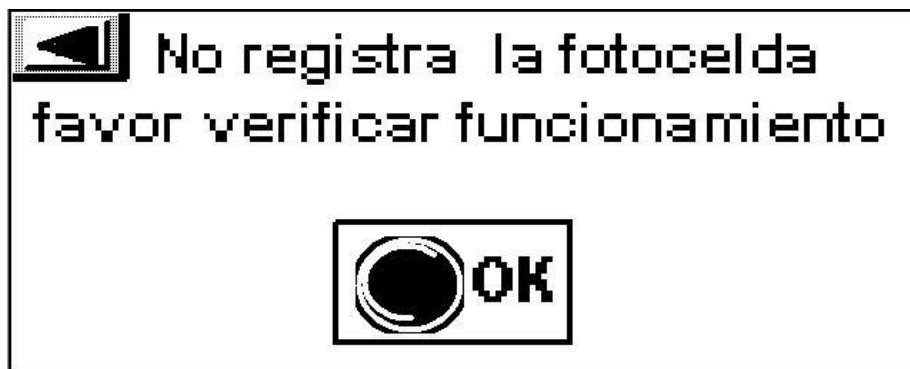
Figura 20 Ventana de alerta por mal funcionamiento de la fotocelda
