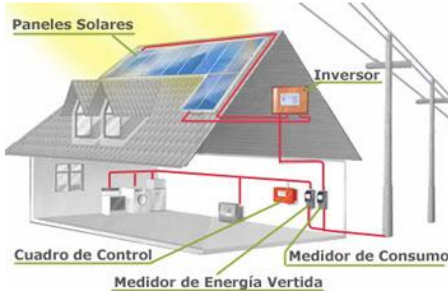
Figura 22. Esquema de funcionamiento de instalación solar fotovoltaica.
