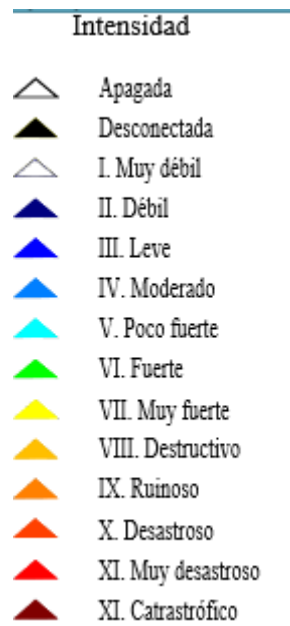
Figura 3.6 Escala de intensidades utilizando acelerógrafos
