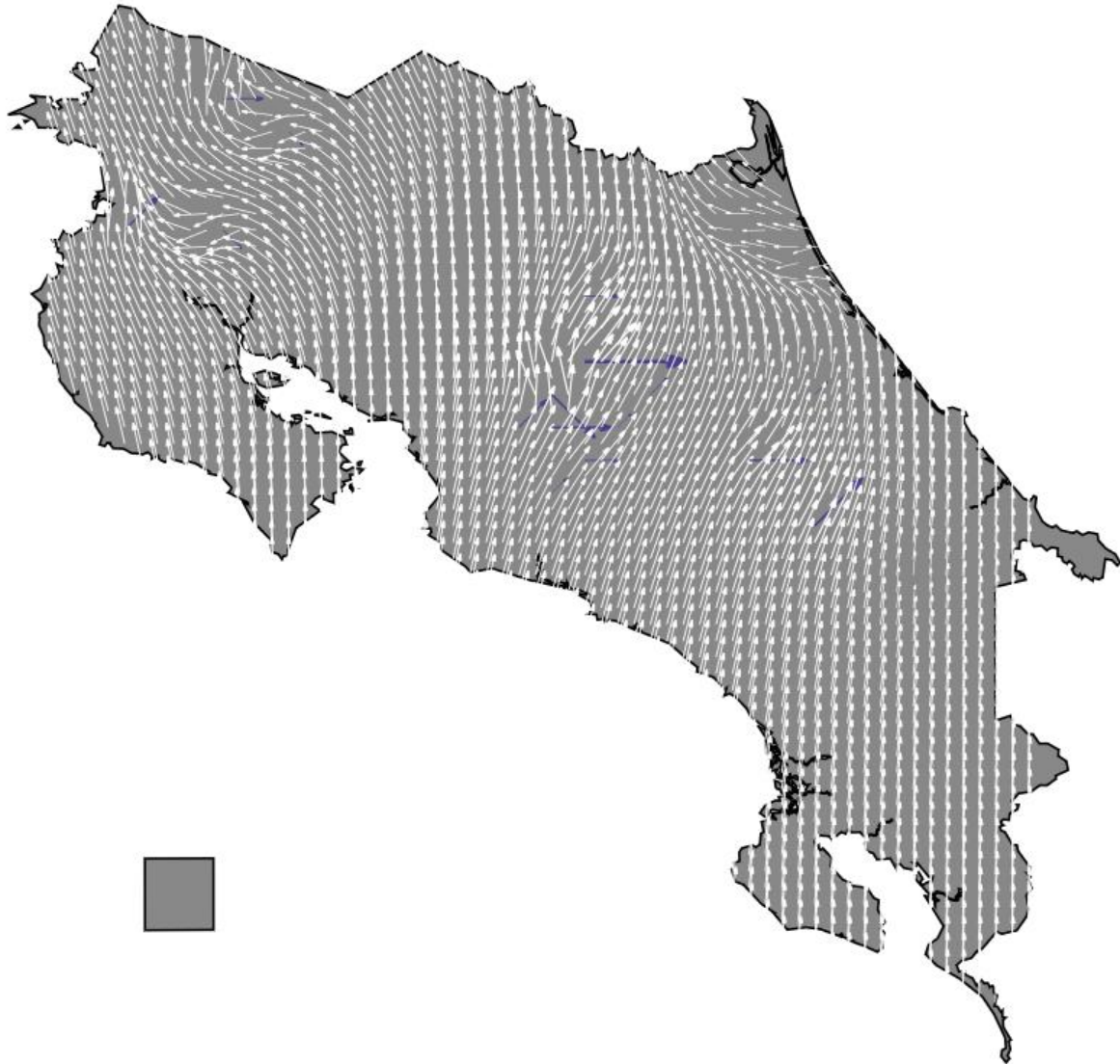
Figura 4.5. Mapa de vientos de Costa Rica del 1 de enero del 2014, interpolación de distancia inversa ponderada con potencia 2
