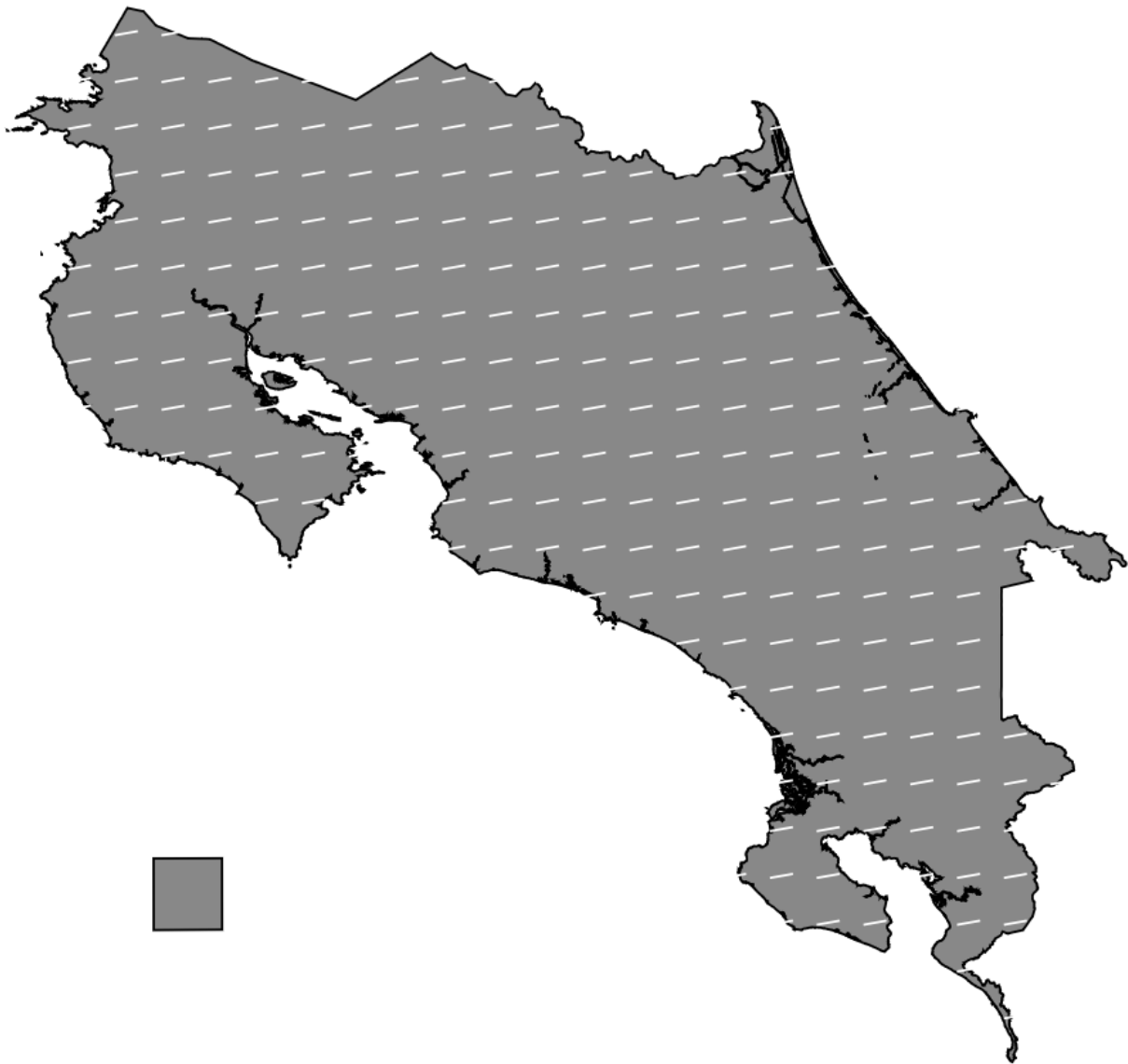
Figura 4.3. Prueba de ejemplo para el algoritmo de distancia inversa ponderada con vientos de 2.5 m/s a 10^\circ
