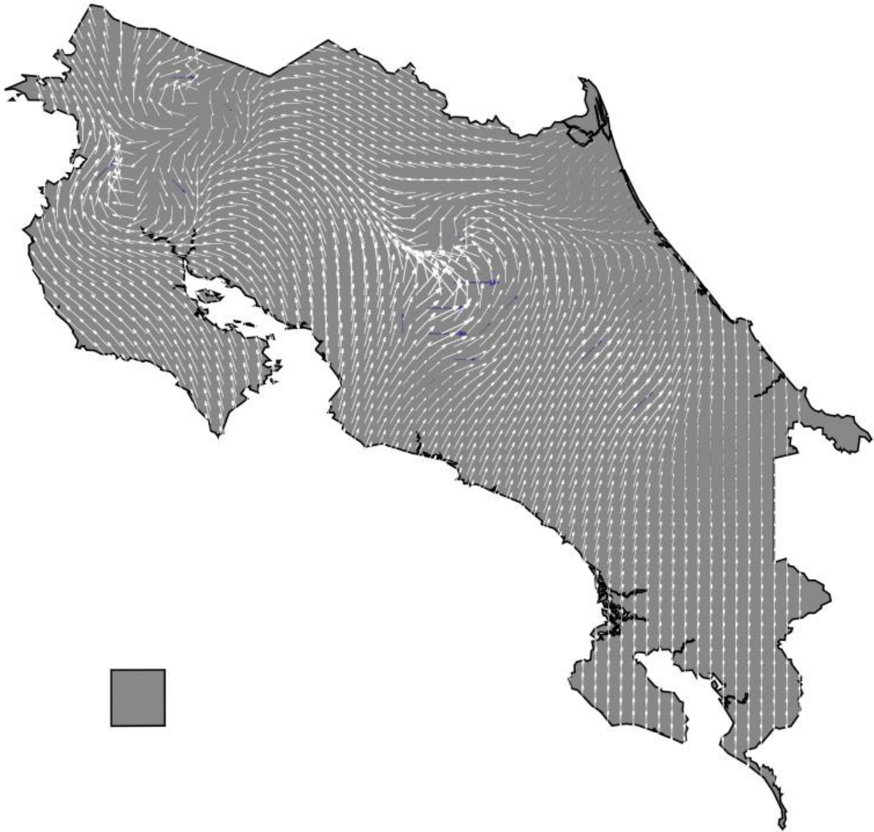
Figura 4.10. Mapa de vientos de Costa Rica del 2 de enero del 2014, interpolación de distancia inversa ponderada con potencia 4
