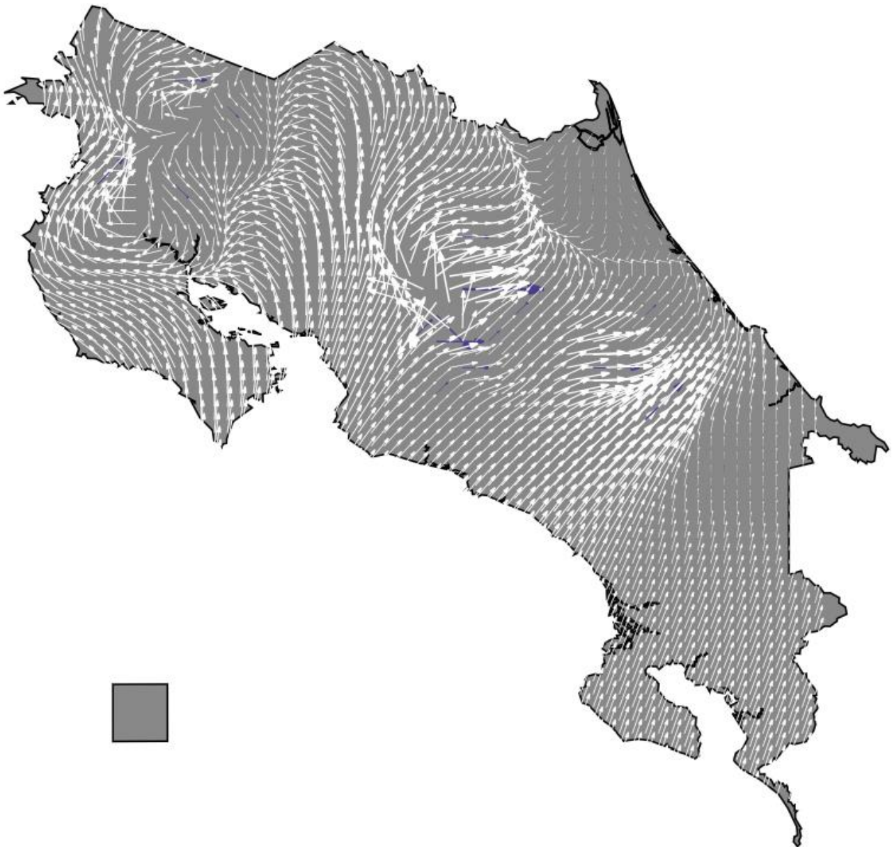
Figura 4.7. Mapa de vientos de Costa Rica del 1 de enero del 2014, interpolación de distancia inversa ponderada con potencia 6
