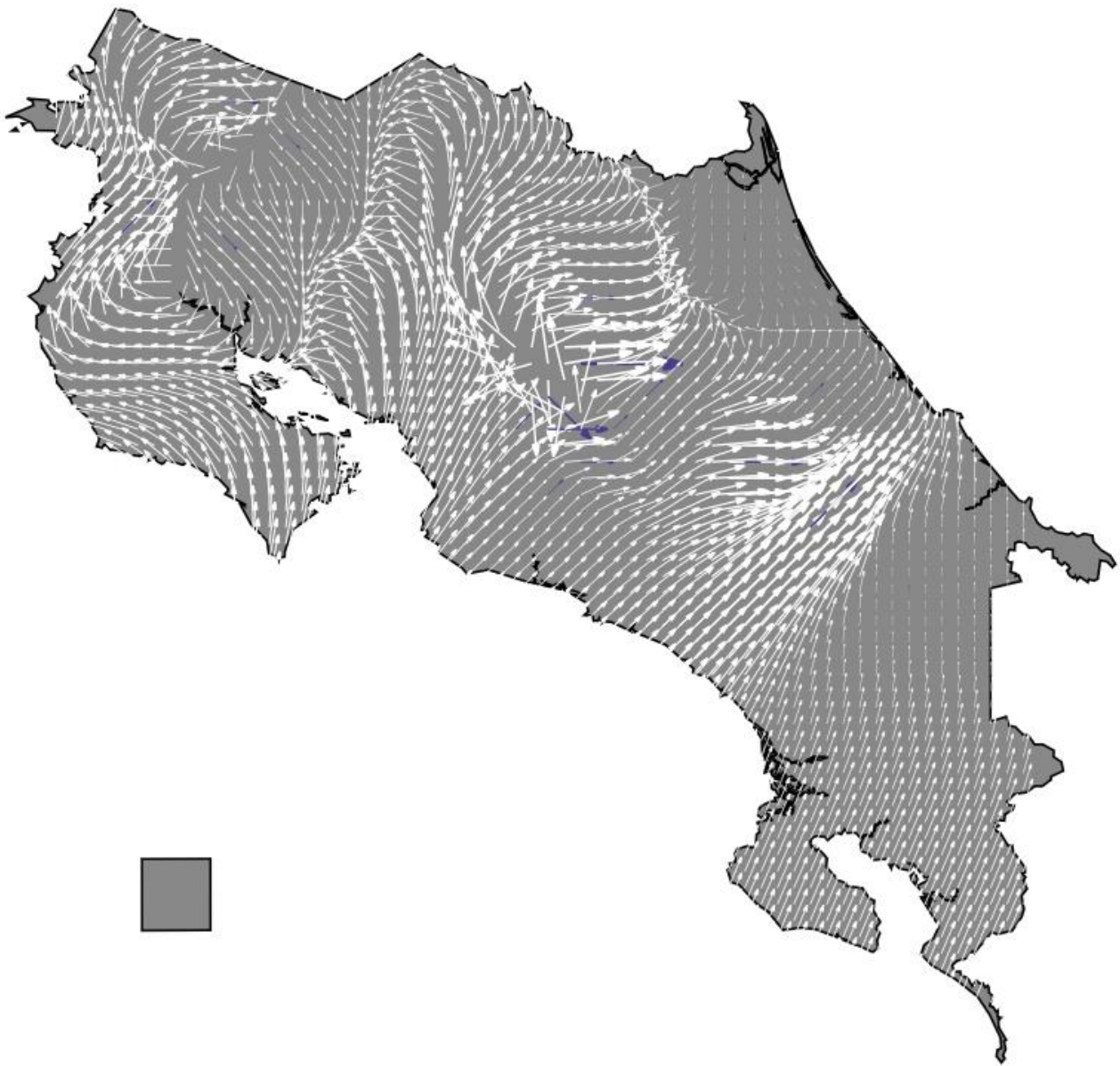
Figura 4.8. Mapa de vientos de Costa Rica del 1 de enero del 2014, interpolación de distancia inversa ponderada con potencia 8
