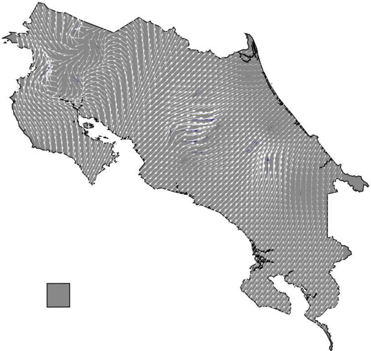
Figura 4.11. Mapa de vientos de Costa Rica del 3 de enero del 2014, interpolación de distancia inversa ponderada con potencia 4
