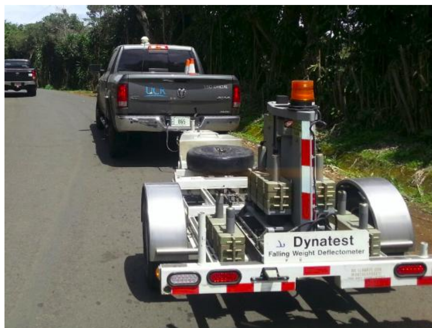
Figura 3.8. Deflectómetro de impacto del LANAMMEUCR.
