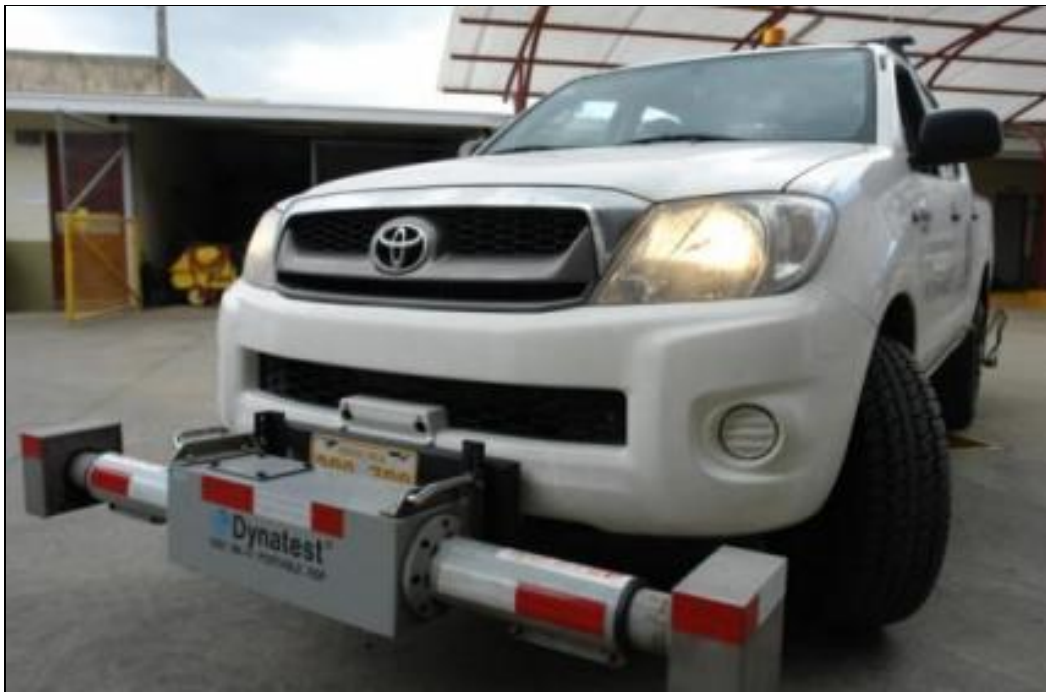
Figura 3.7. Perfilómetro inercial láser del LANAMMEUCR.
