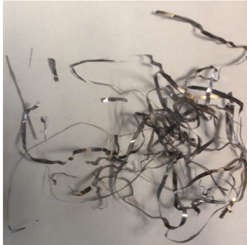
Figura 35. Cintas obtenidas del proceso de solidificación ultrarrápida
