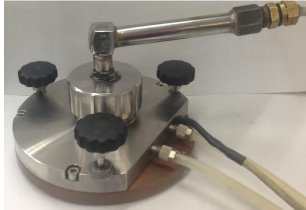
Figura 33. Sistema de presión del colado por succión
