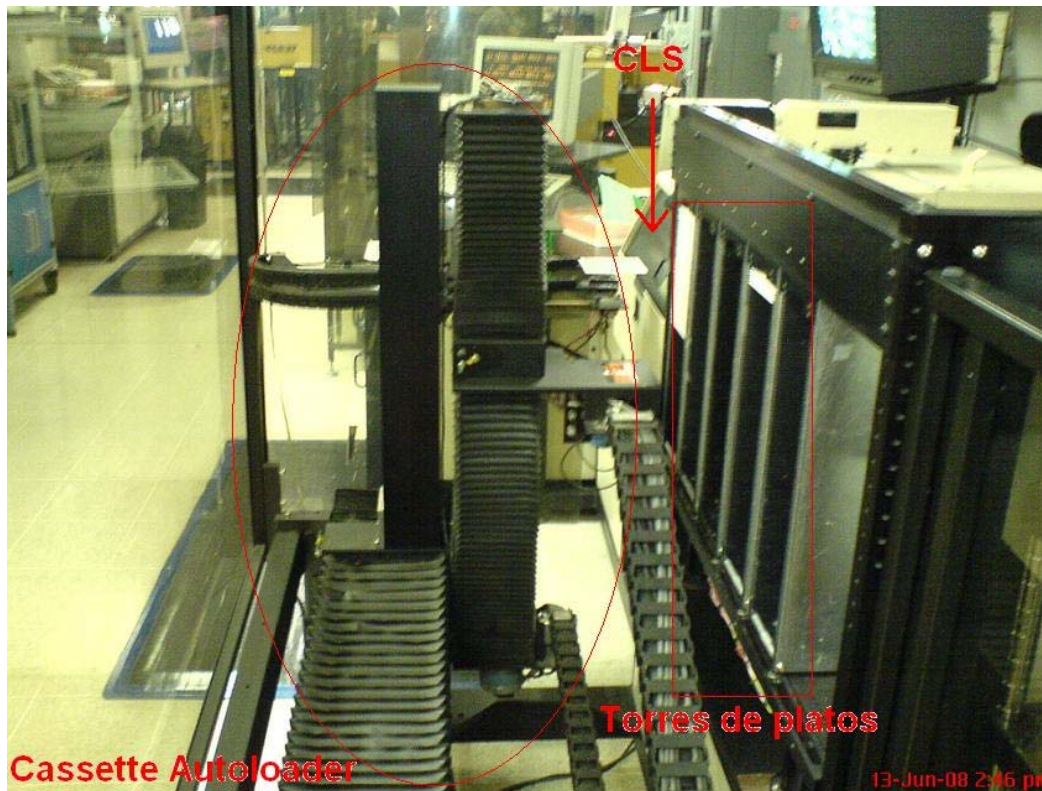
Figura 1.1.A. Brazo robótico manipulador de platos cerámicos acoplado al sistema de ajuste de valores resistivos por medio de láser (CLS).
