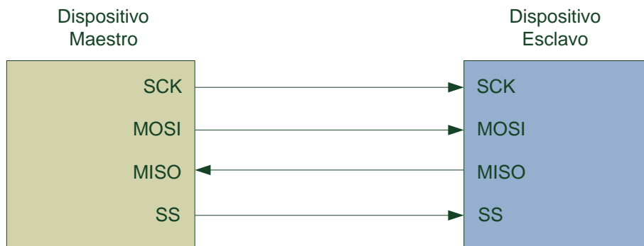
Figura 9. Esquema de comunicación SPI para un solo periférico.
