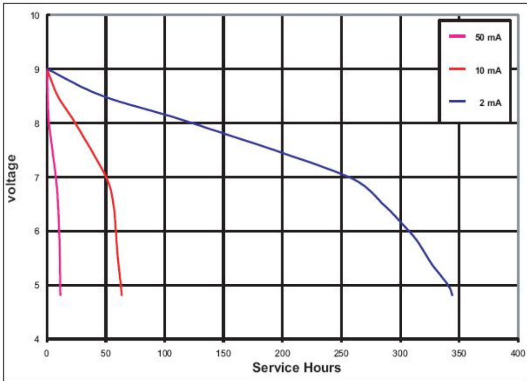
Figura 39. Característica de descarga teórica de una batería Duracell de 9V.
