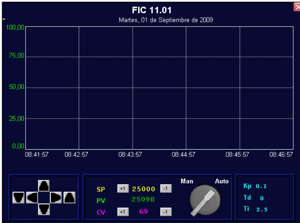
**Figura 36.** Pantalla de manejo y visualización de variables para los lazo de control.
