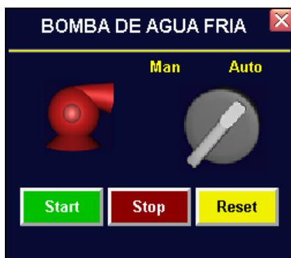
**Figura 34.** Pantalla de manejo y visualización de bombas de arranque directo.
