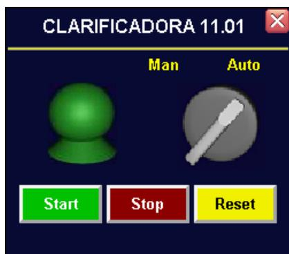
**Figura 33.** Pantalla de manejo y visualización de motores de arranque directo.
