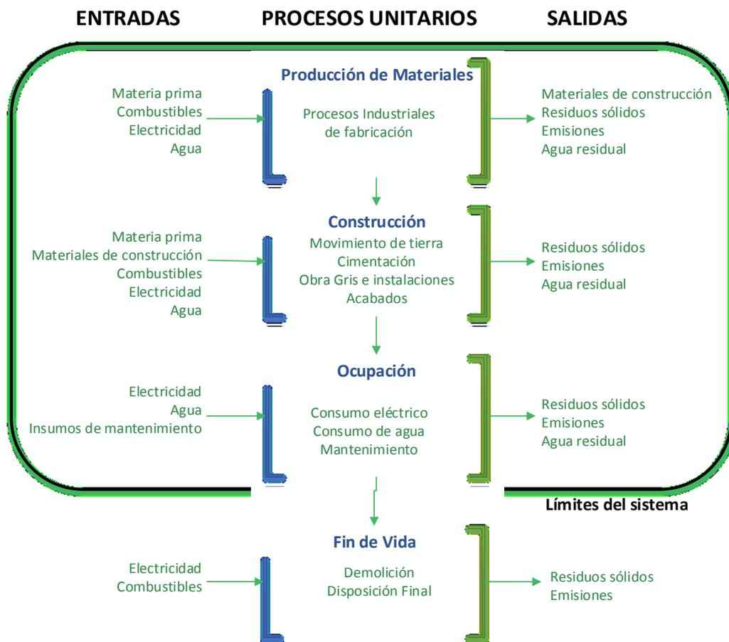
Figura 4-1 Diagrama de Flujo del ACV del Edificio.
