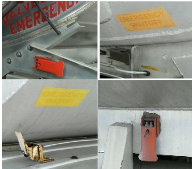
Figura 4.9 Válvulas de paro de emergencia observadas en la mayoría de los camiones cisterna evaluados.
