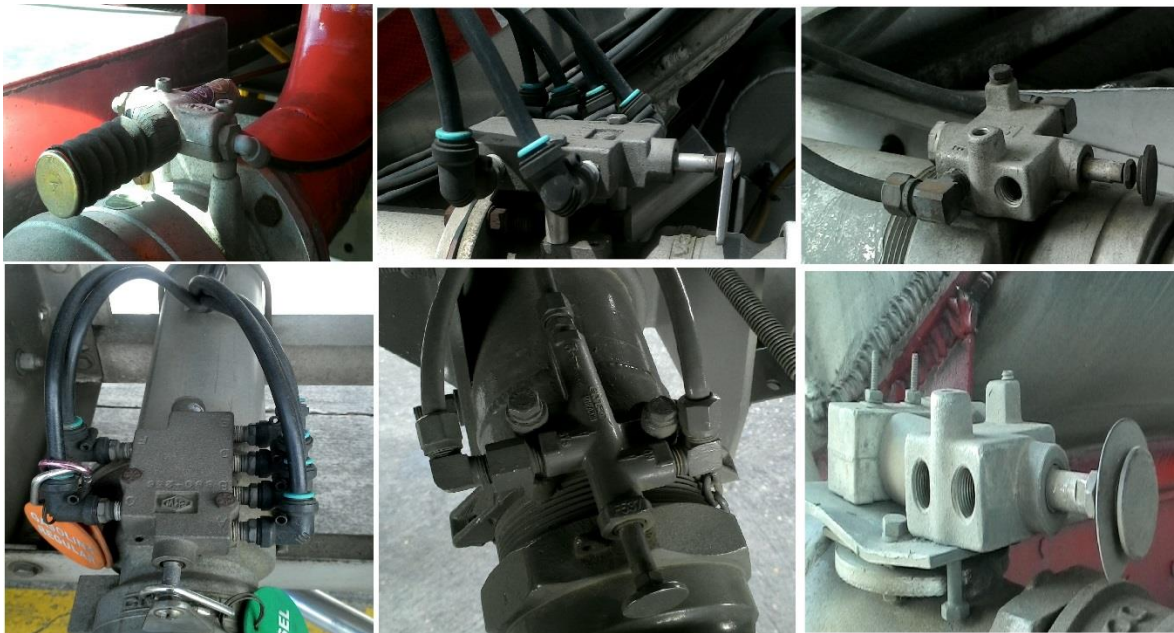
Figura 4.7 Válvulas neumáticas observadas en los camiones cisterna evaluados.
