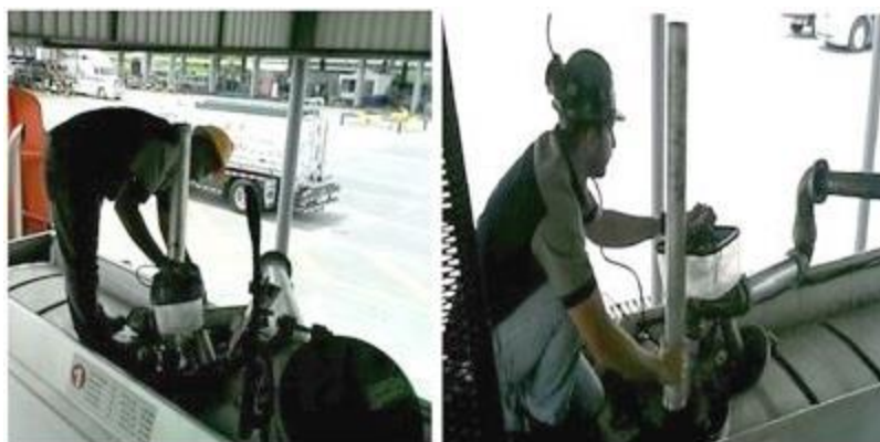
Figura 4.14 Toma de muestra método de carga actual de combustible limpio utilizando el ducto conductor de los vapores de COV's generados.
