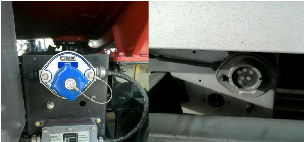
Figura 4.2 Sistema de control de sobrellenado con sensores ópticos y Enchufe (socket) de conexión\ Receptáculos Izquierda completo vs. derecha incompleto
