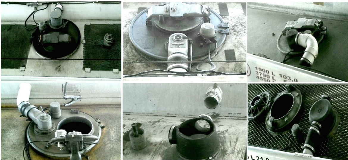
Figura 4.6 Diferentes tipo de dispositivos de venteos, tubing (tuberías conductoras de aire comprimido), accesorios, sensores ópticos y manhole encontrados
