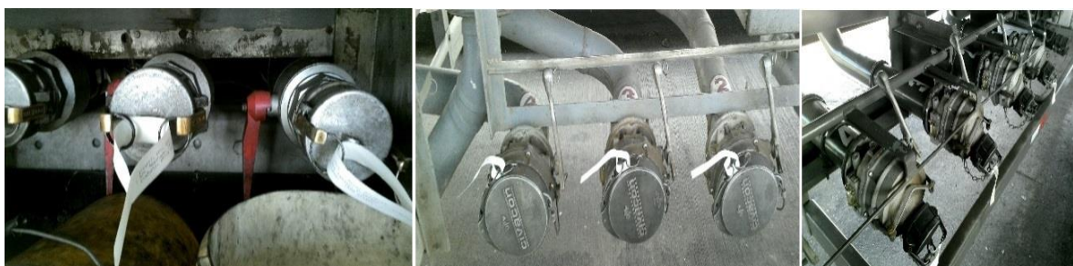
Figura 4.8 Diferentes tipos de válvulas observadas en los camiones cisternas para la descarga del combustible limpio.
