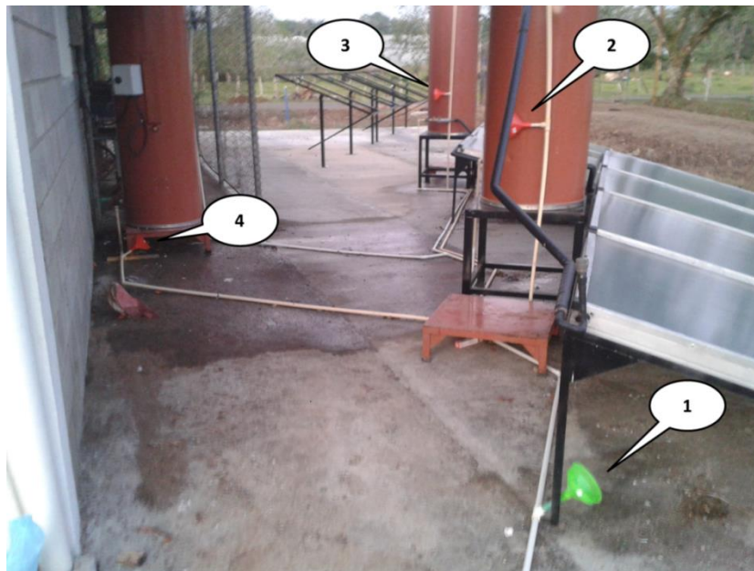
Figura 2. Distribución de los termómetros colocados en el sistema de colectores solares.
