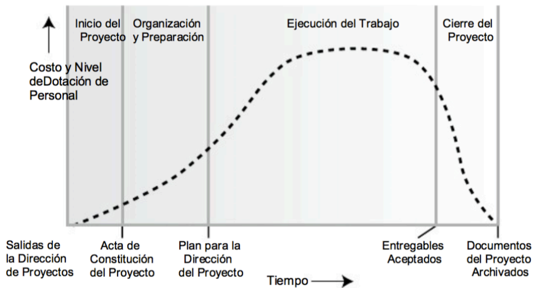
Figura 2.1 Niveles Típicos de Costo y Dotación de Personal en una Estructura Genérica del Ciclo de Vida del Proyecto.
