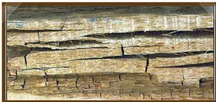
Figura 3, Tipo de pudrición parda en una pieza de madera. Fuente: Dávalos Sotelo, R. (2010).
