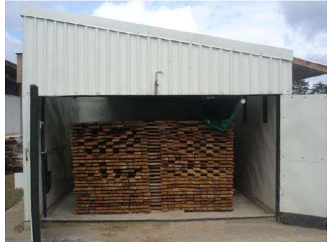
Figura 04. Secado solar Fuente: Salas (s.f.)
