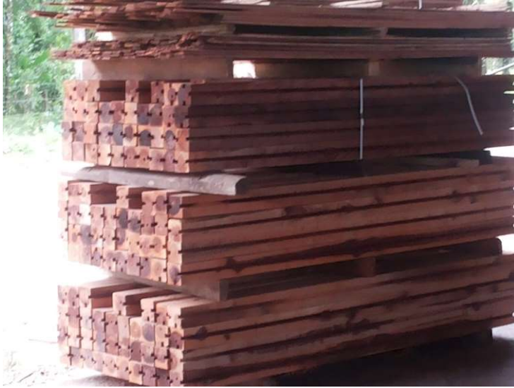
Figura 58, anexo: Columnas de pilón para la elaboración de casas. Fuente: elaboración propia de la empresa Ecocajas.
