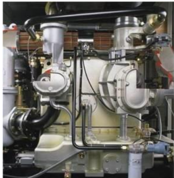
Figura II.2 Compresor de tornillo de dos etapas Sierra H 300W
