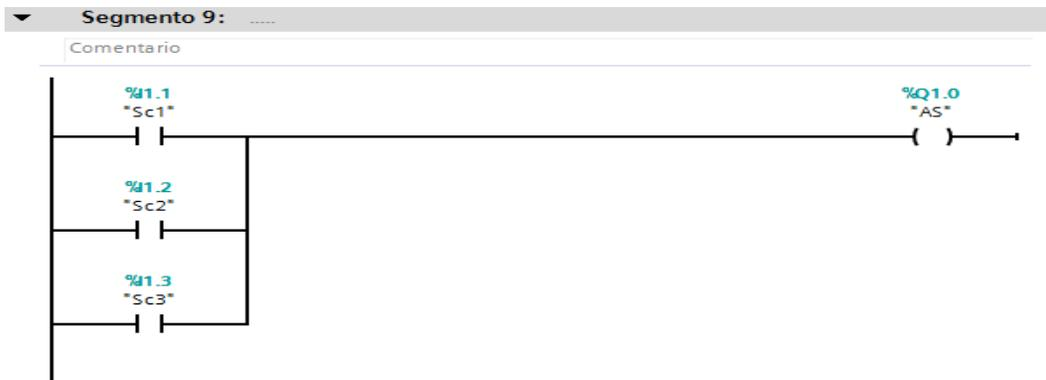
El segmento 9 indica que al activarse cualquiera de las 3 sobrecargas se activará la alarma de sobrecargas, la cual para el sistema.
