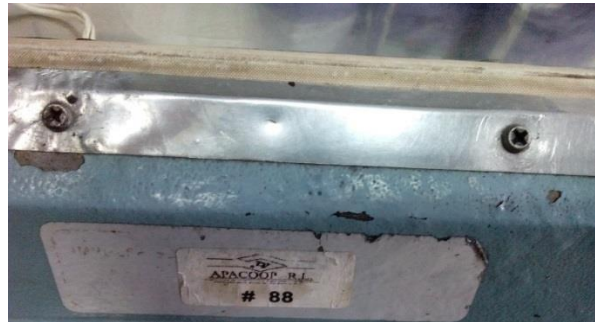
Figura 3.11. Tornillos a quitar en la termo-selladora manual.
