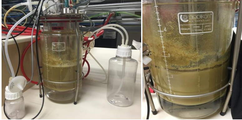
Figura 18. Biorreactores tipo tanque agitado con cultivo celular de A. indica en fase exponencial. Fuente: CENIBiot, 2016
