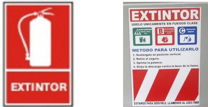
Figura V-21. Señalización para extintores portátiles.
