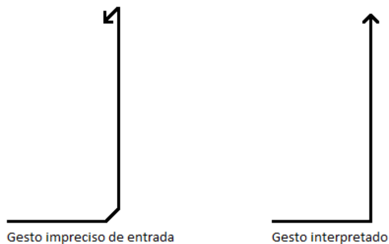
FIGURA 4.12: Hilera de gesto almacenado vs. hilera de gesto impreciso de entrada (visualización simplificada)
